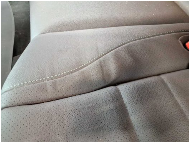
Beschädigung #14: Sitz hinten: Sitzbezug - Delle(n) - erneuern
