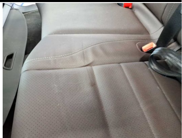
Beschädigung #14: Sitz hinten: Sitzbezug - Delle(n) - erneuern
