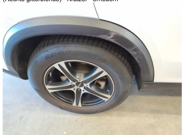
Beschädigung #6: Seitenwand rechts: Radhausverbreiterun... Kratzer - erneuern
