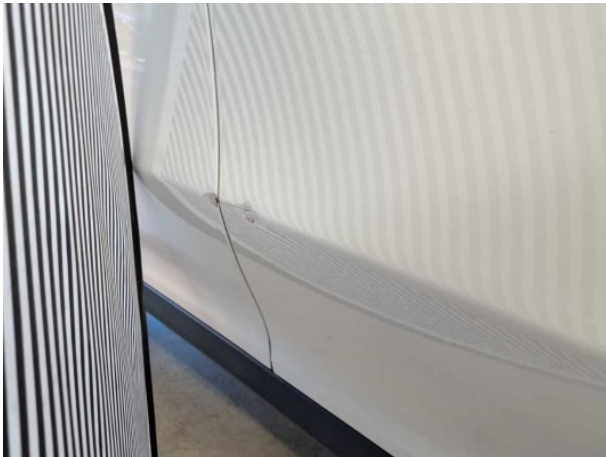
Beschädigung #13: Tür vorn rechts: Tür - verformt - erneuern
