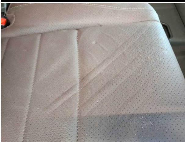
Beschädigung #14: Sitz hinten: Sitzbezug - Delle(n) - erneuern
