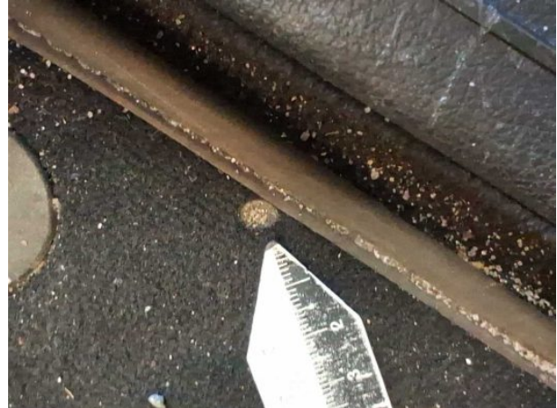
Beschädigung #1: Verkleidungen/Abdeckungen: Fußmatten - Löcher - erneuern
