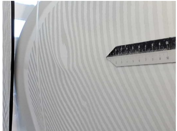
Beschädigung #13: Tür vorn rechts: Tür - verformt - erneuern
