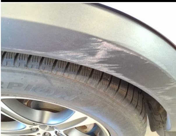
Beschädigung #6: Seitenwand rechts: Radhausverbreiterung - Kratzer - erneuern
