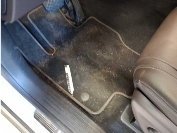
Beschädigung #1: Verkleidungen/Abdeckungen: Fußmatten - Löcher - erneuern
