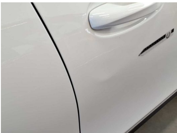
Beschädigung #13: Tür vorn rechts: Tür - verformt - erneuern
