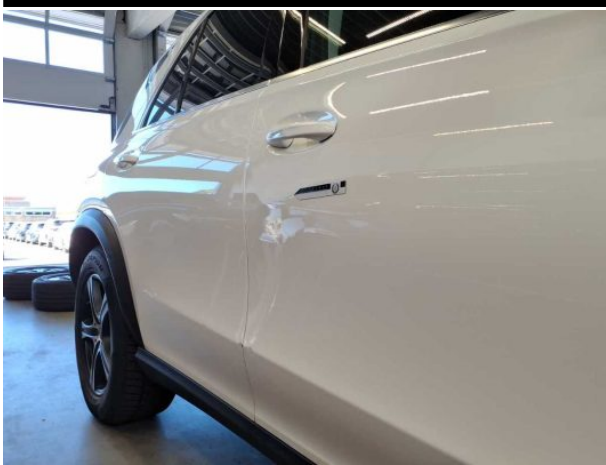
Beschädigung #13: Tür vorn rechts: Tür - verformt - erneuern
