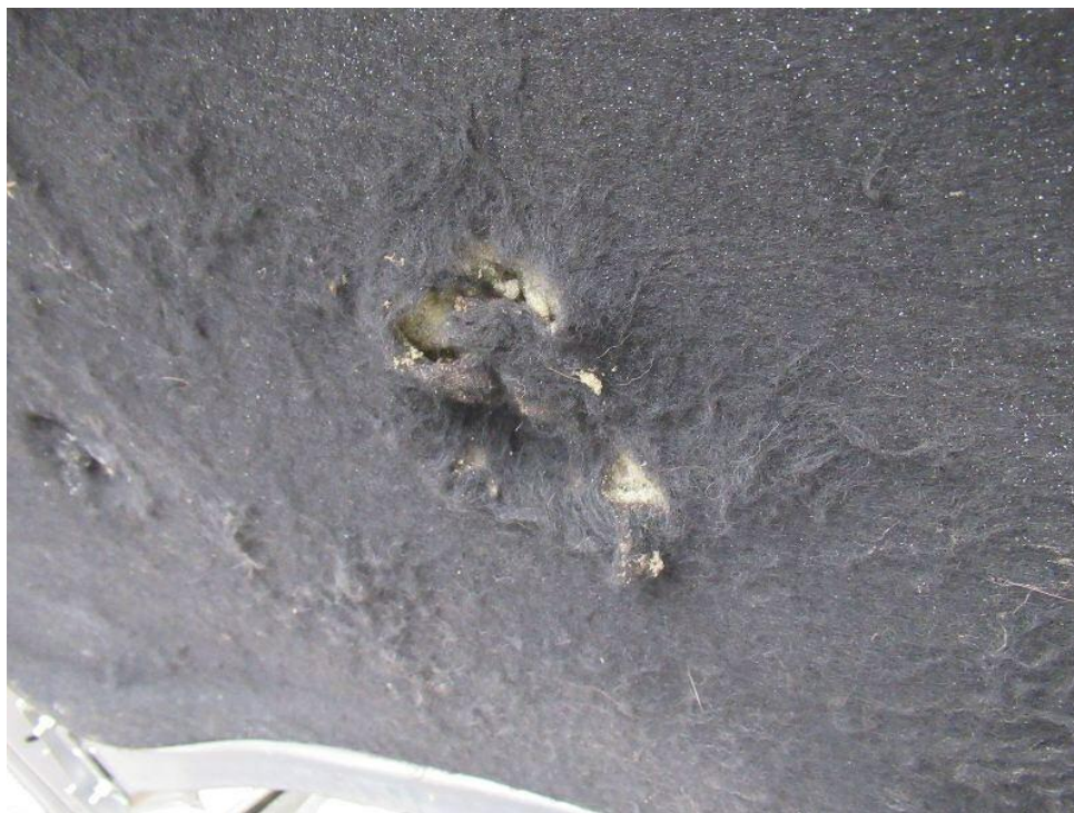
Bild 21 : Motorhaube: Dämm/Schallschutz beschädigt (Nager).
