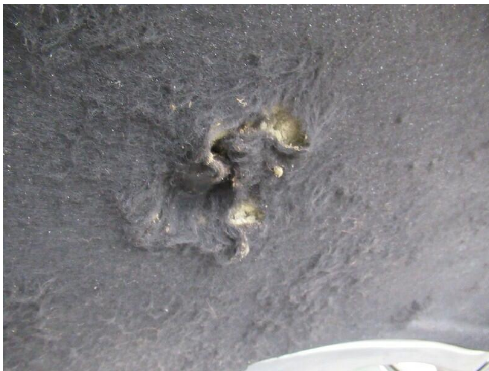
Bild 22 : Motorhaube: Dämm/Schallschutz beschädigt (Nager).
