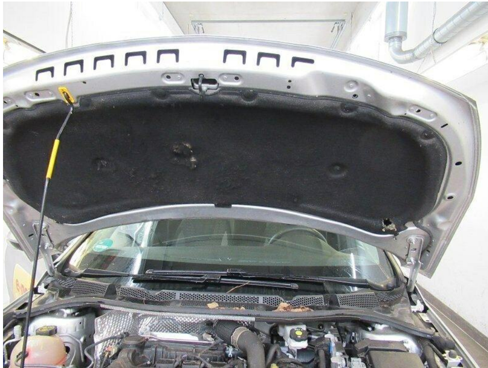
Bild 19 : Motorhaube: Dämm/Schallschutz beschädigt (Nager).
