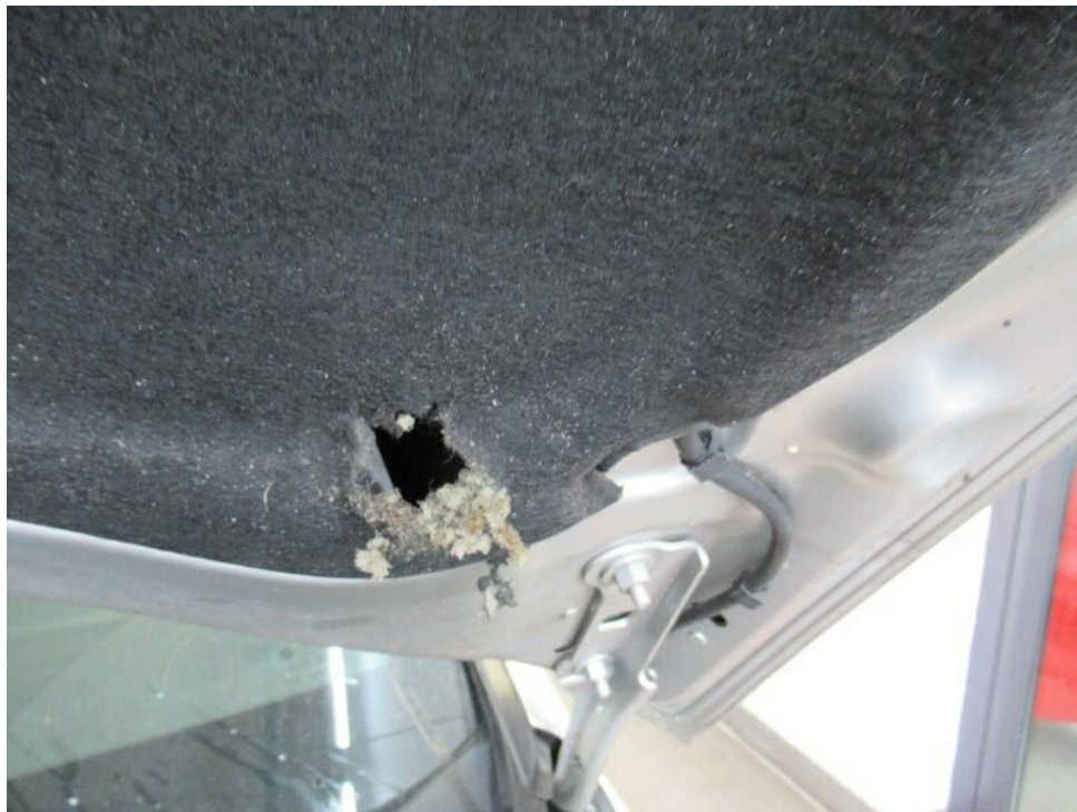
Bild 20 : Motorhaube: Dämm/Schallschutz beschädigt (Nager).
