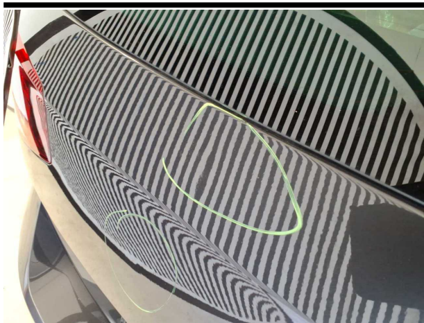
Beschädigung #4: Heckklappe/-tür: Heckklappe - Delle(n) - sanft instandsetzen
