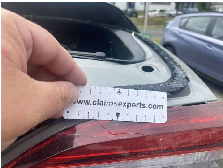
Bild 12 Rückleuchte hinten rechts gebrochen
