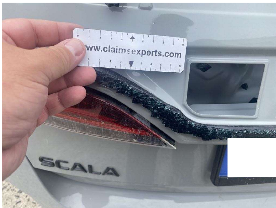
Bild 8 Heckscheibe gebrochen und gesplittert
