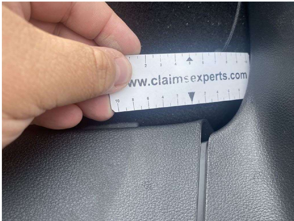
Bild 15 Verkleidung Heckdeckel verformt
