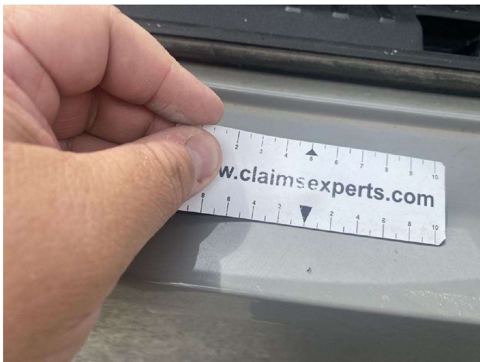
Bild 14 Stoßfängerverkleidung hinten kratzbeschädigt
