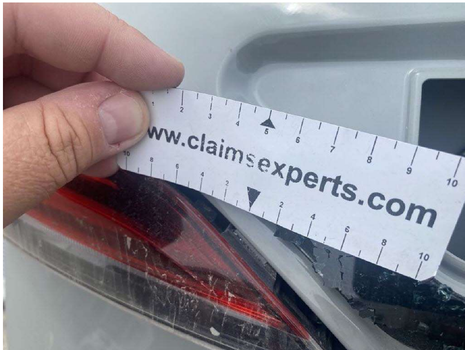
Bild 13 Rückleuchte hinten links verformt
