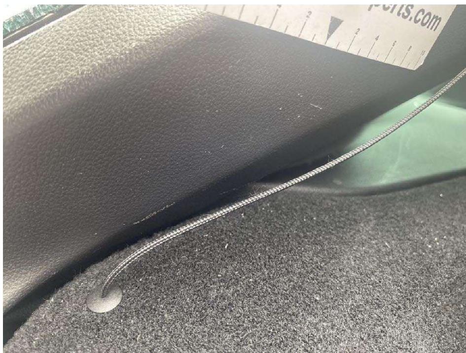
Bild 16 Verkleidung Heckdeckel kratzbeschädigt
