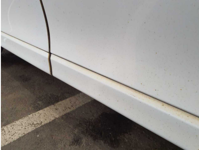
Damage 8: Body: Body (Flugrost-Mehrkosten möglich) - Soiled - Conditioning
