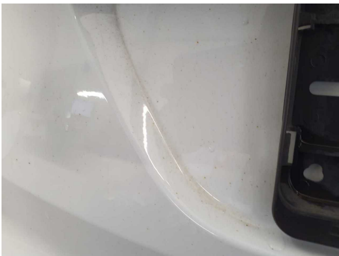
Damage 8: Body: Body (Flugrost-Mehrkosten möglich) - Soiled - Conditioning
