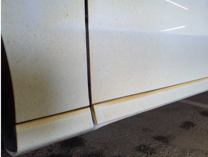
Damage 8: Body: Body (Flugrost-Mehrkosten möglich) - Soiled - Conditioning
