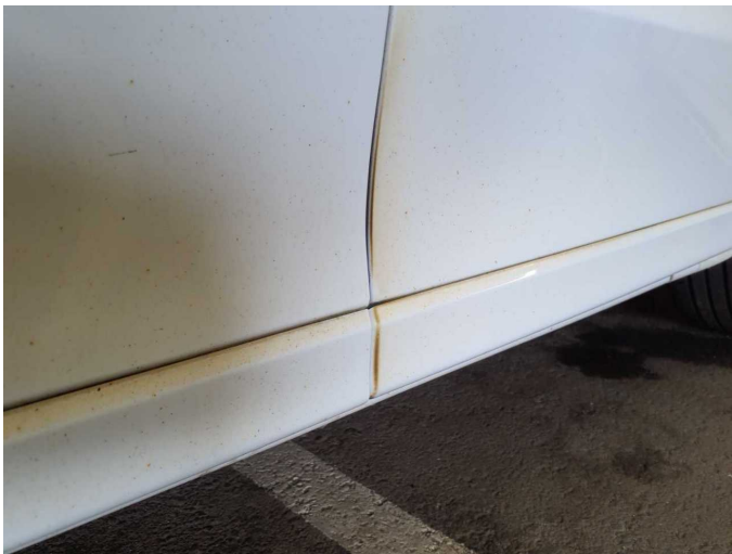
Damage 8: Body: Body (Flugrost-Mehrkosten möglich) - Soiled - Conditioning
