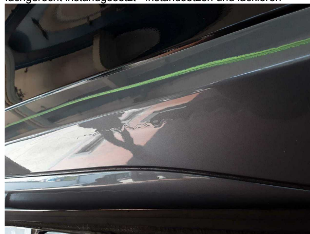
Beschädigung #5: Tür vorn rechts: Tür (Lackläufer) - nicht fachgerecht instandgesetzt - instandsetzen und lackieren
