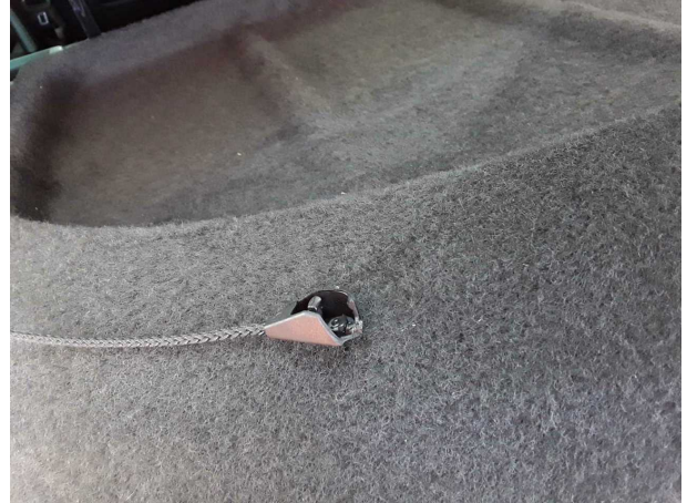
Beschädigung #1: Interieur: Laderraumabdeckung / Rollo (Halterung) - beschädigt - erneuern
