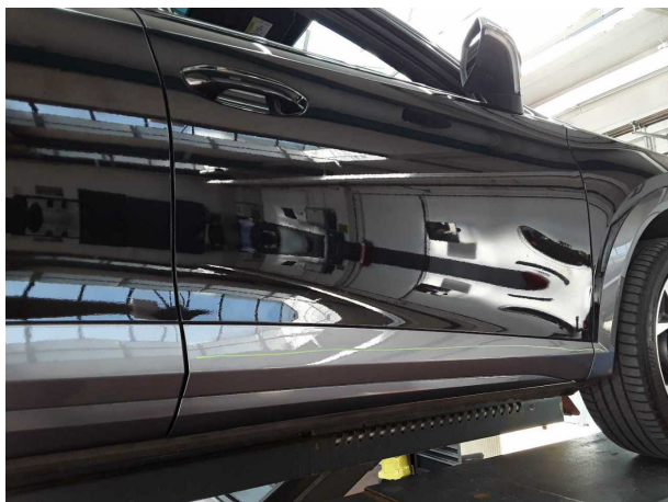
Beschädigung #5: Tür vorn rechts: Tür (Lackläufer) - nicht fachgerec... instandgesetzt - instandsetzen und lackieren
