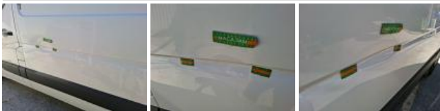
Door trim FL, Scratch(es), Replace
