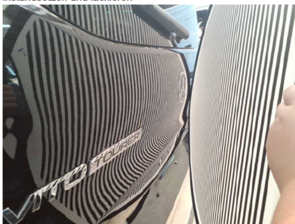
Heckklappe/-tür: Heckklappe - Delle / Lackschaden - instandsetzen und lackieren
