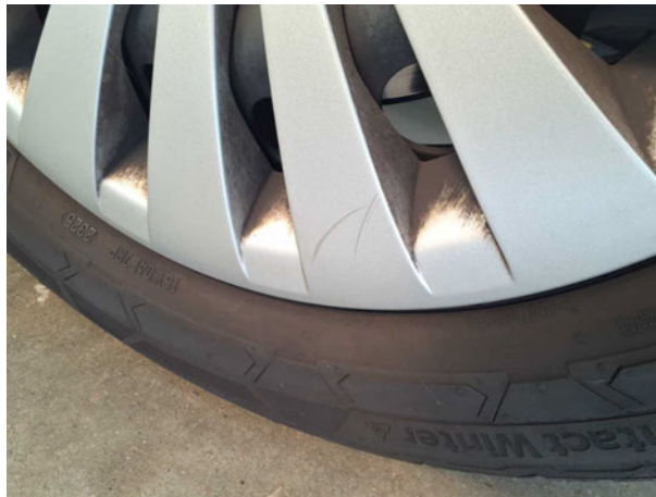
Rad/Reifen: Radblende vorn rechts - verkratzt / verschürft - erneuern
