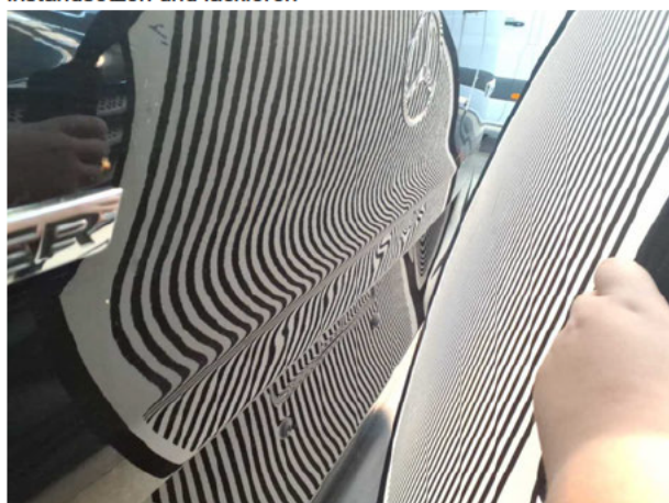
Heckklappe/-tür: Heckklappe - Delle / Lackschaden - instandsetzen und lackieren
