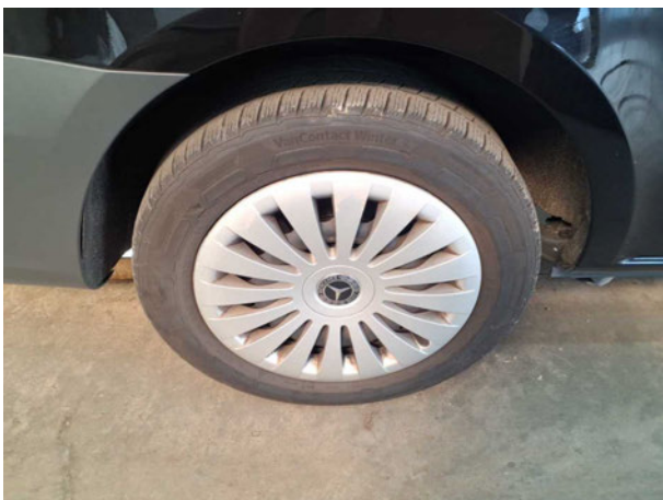
Rad/Reifen: Radblende hinten rechts - verkratzt / verschürft - erneuern
