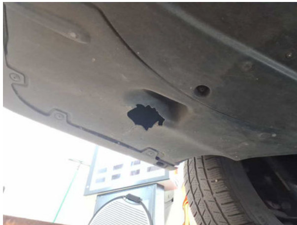
Karosserie: Unterbodenverkleidung (H) - gebrochen / gerissen - erneuern
