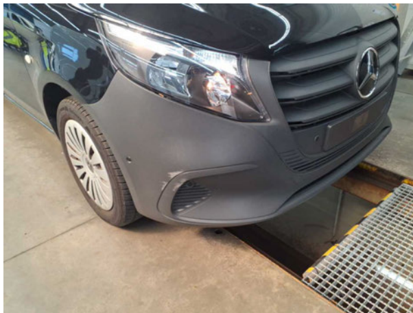
Stoßfänger vorn: Stoßfänger mit Parktronic - verkratzt / verschürft - Smart Repair
