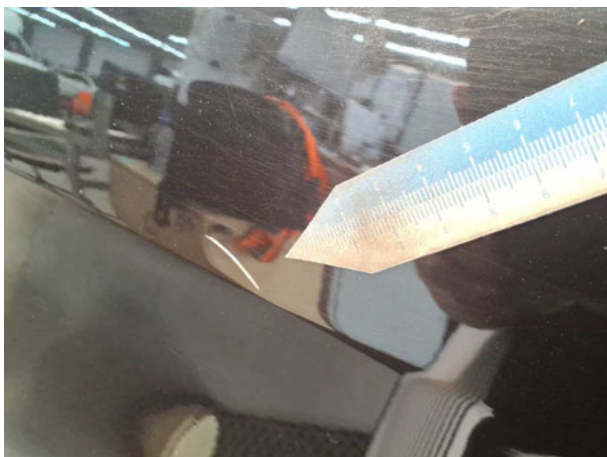
Schiebetür rechts: Schiebetür mit Glasscheibe - Delle / Lackschaden - instandsetzen und lackieren
