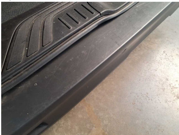
Stoßfänger hinten: Stoßfänger mit Parktronic - verkratzt / verschürft - Smart Repair
