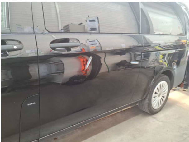
Schiebetür links: Schiebetür mit Glasscheibe - Delle(n) - Smart Repair
