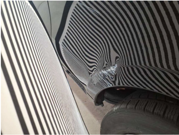
Seitenwand links: Seitenwand hinten unterhalb - Delle / Lackschaden - instandsetzen und lackieren
