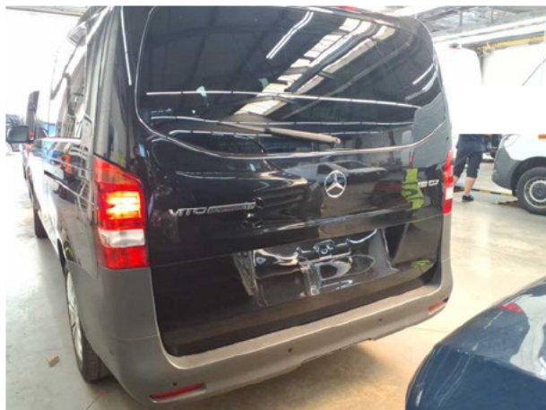
Heckklappe/-tür: Heckklappe - Delle / Lackschaden - instandsetzen und lackieren
