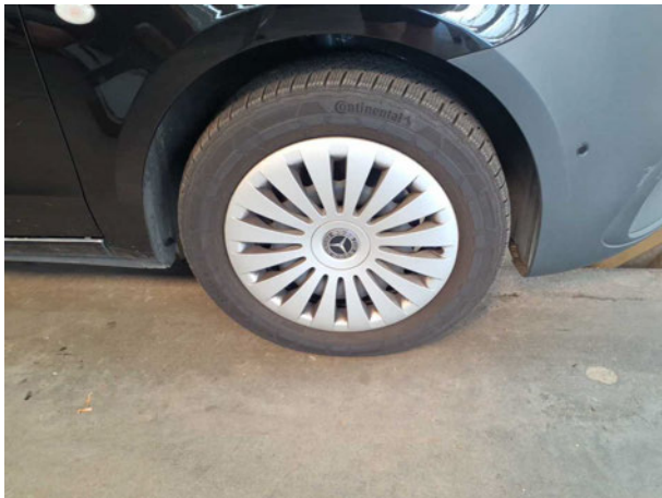
Rad/Reifen: Radblende vorn rechts - verkratzt / verschürft - erneuern
