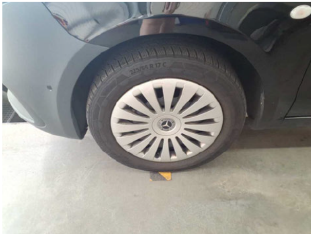
Rad/Reifen: Radblende vorn links - verkratzt / verschürft - erneuern
