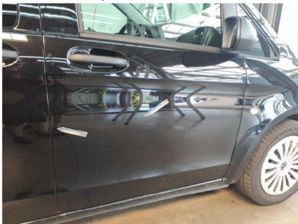
Tür vorn rechts: Tür - Delle / Lackschaden - Smart Repair
