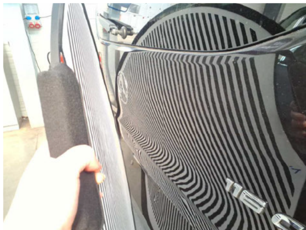
Heckklappe/-tür: Heckklappe - Delle / Lackschaden - instandsetzen und lackieren
