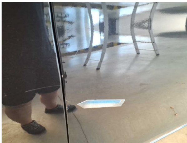
Tür vorn rechts: Tür - Delle / Lackschaden - Smart Repair
