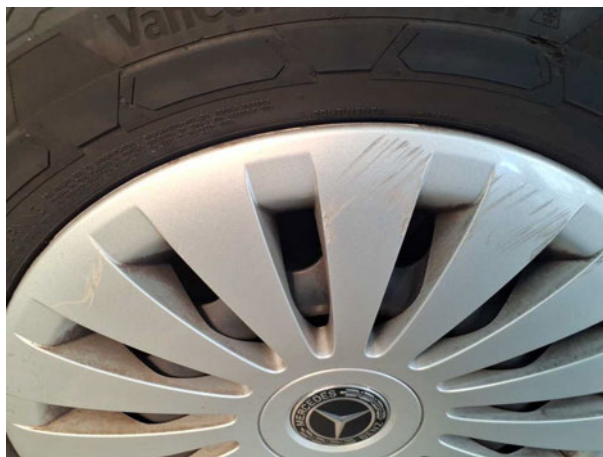
Rad/Reifen: Radblende hinten rechts - verkratzt / verschürft - erneuern
