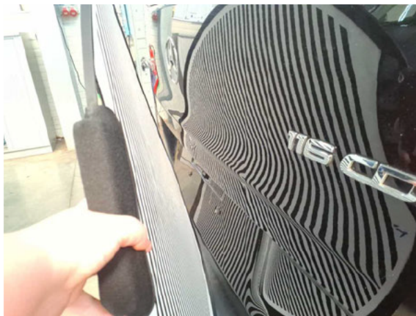
Heckklappe/-tür: Heckklappe - Delle / Lackschaden - instandsetzen und lackieren
