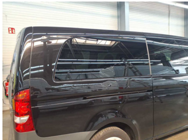
Seitenwand rechts: Seitenwand hinten oberhalb (+ leiste) - Delle / Lackschaden - instandsetzen und lackieren
