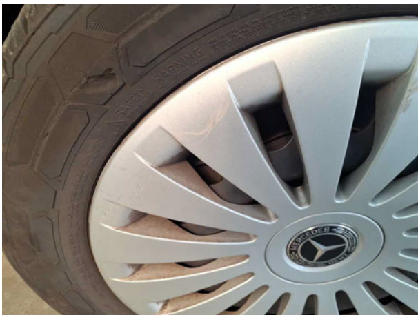
Rad/Reifen: Radblende hinten rechts - verkratzt / verschürft - erneuern
