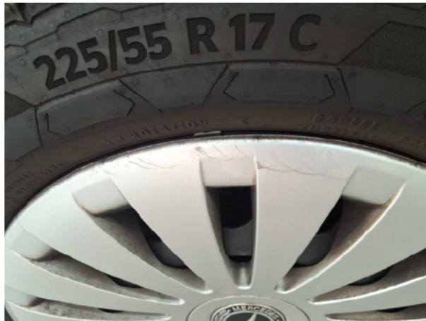
Rad/Reifen: Radblende vorn links - verkratzt / verschürft - erneuern
