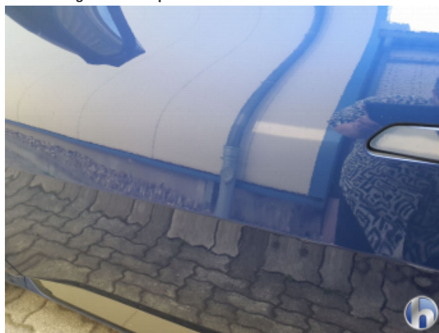
3. Tür Vorne - Links Verdellt - Sanft Instandsetzen
