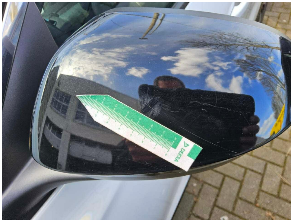
Bild 15 : Außenspiegel links Lackierung, zerkratzt, smart repair
