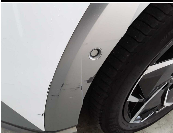
Beschädigung #3: Kotflügel links: Radhausverbreiterung - verkratzt / verschürft - erneuern
