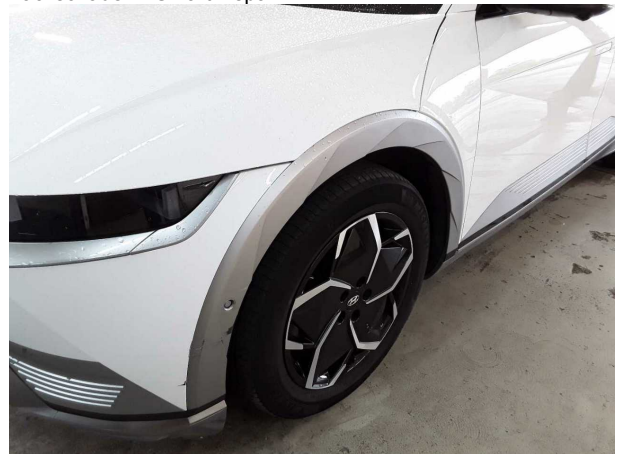
Beschädigung #3: Kotflügel links: Radhausverbreiterung - verkratzt / verschürft - erneuern
