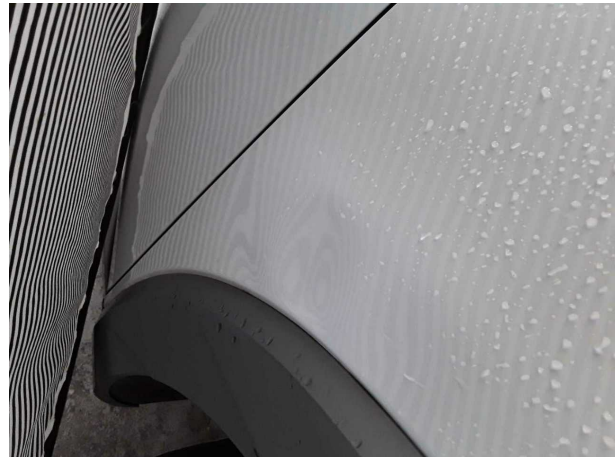
Beschädigung #9: Kotflügel rechts: Kotflügel rechts - verformt - erneuern
