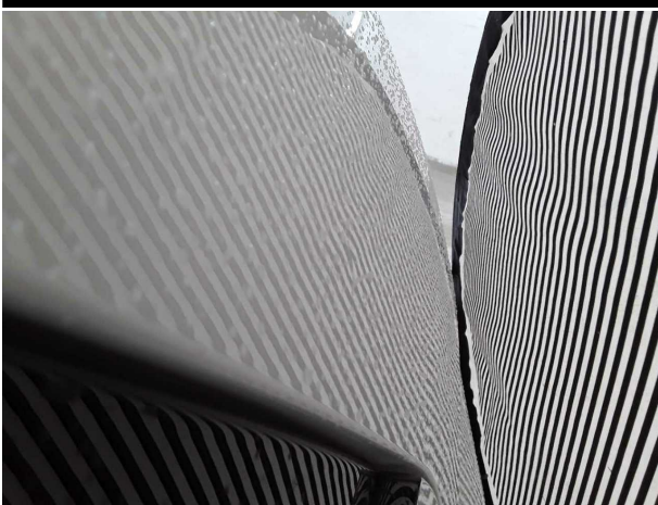
Beschädigung #8: Seitenwand links: Seitenwand - Delle / Lackschaden - instandsetzen und lackieren
