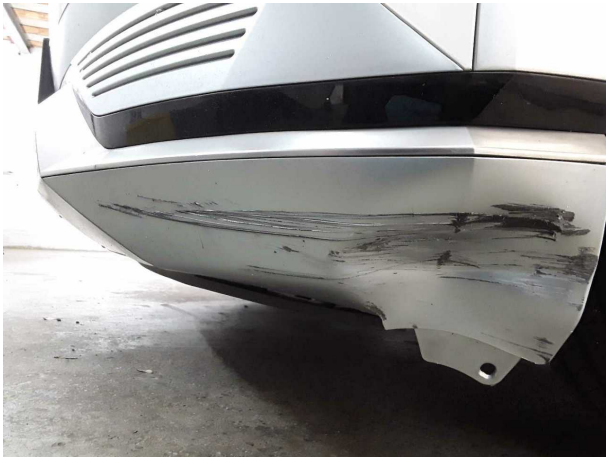
Beschädigung #4: Stossfänger vorn: Spoiler - beschädigt - erneuern
