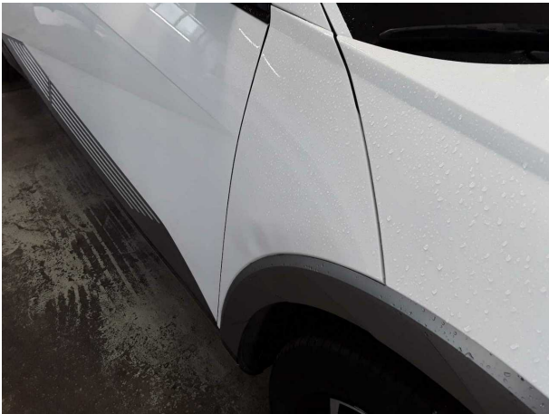
Beschädigung #9: Kotflügel rechts: Kotflügel rechts - verformt - erneuern
