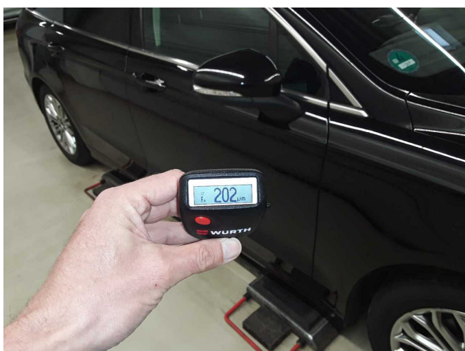
Door - front right side: 202 µm
