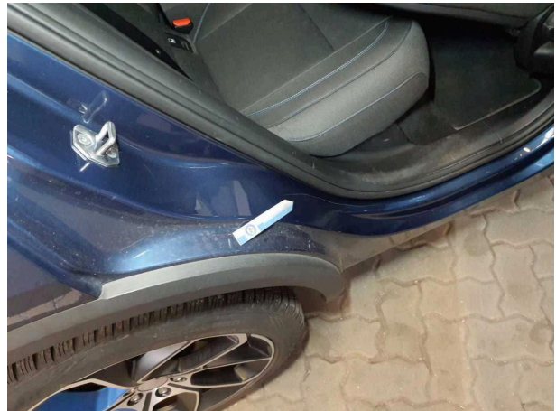
Beschädigung #3: Seitenwand rechts: Einstieg - Kratzer - lackieren
