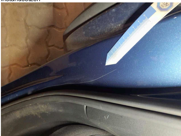
Beschädigung #3: Seitenwand rechts: Einstieg - Kratzer - lackieren
