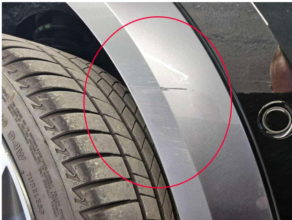
Bild 15 : Kotflügel vorne rechts Zierleiste Lackierung, verschrammt, smart repair
