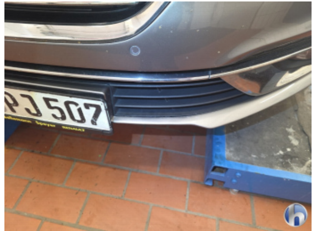
3. Stoßfänger Vorne Befestigung Schadhaft - Erneuern
