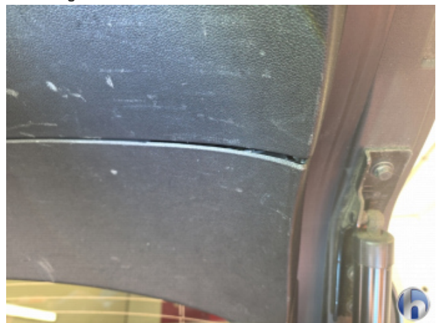
2. Heckklappe Beschädigt - Nacharbeiten
