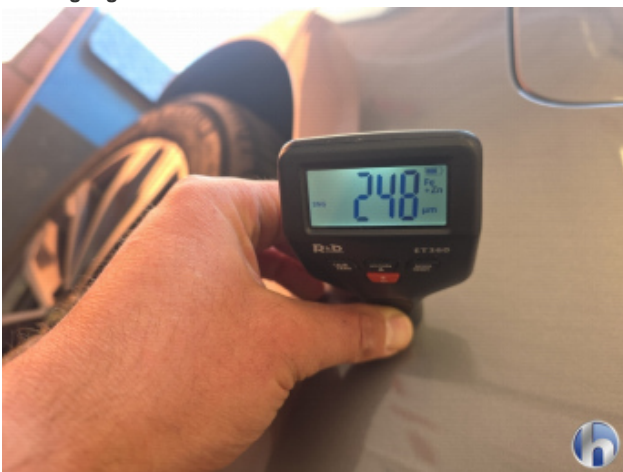
5. Seitenwand - Hinten - Rechts Nachlackiert - Ohne Reparatur
