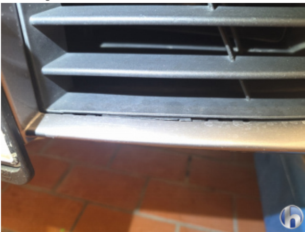
3. Stoßfänger Vorne Befestigung Schadhaft - Erneuern
