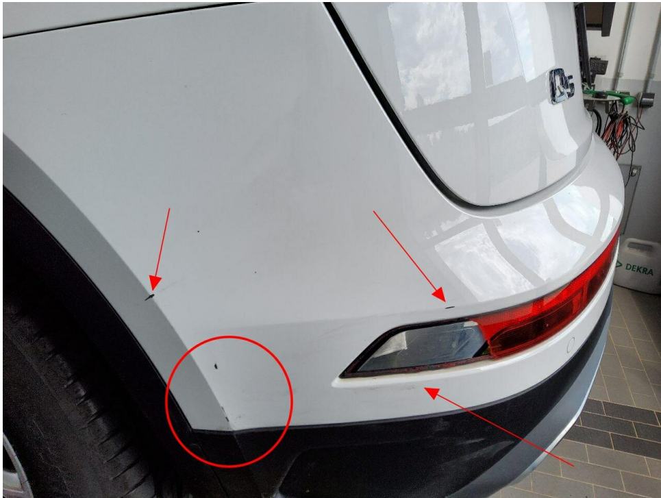
Bild 14 : Unfallschaden: Stoßfänger hinten links seitlich verschrammt und verlagert
