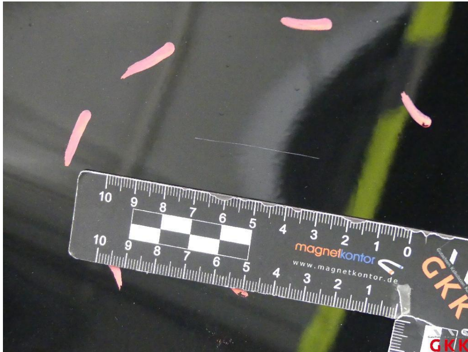
Bild 17 Seitenwand rechts, verkratzt, lackieren
