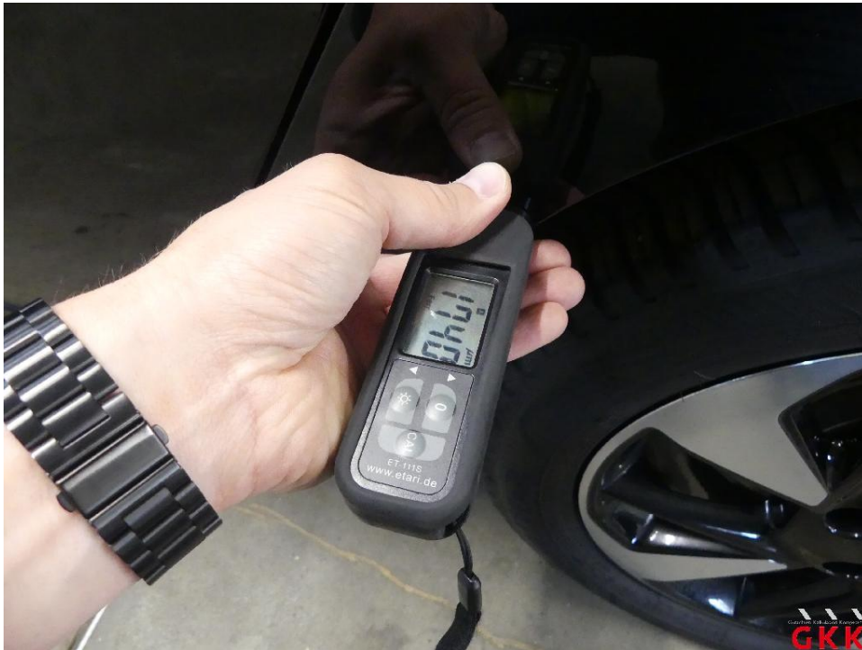
Bild 23 Seitenwand links, Reparaturmangel, instand setzen
