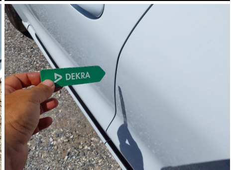
Puerta / Trasero izquierdo / Abolladura
