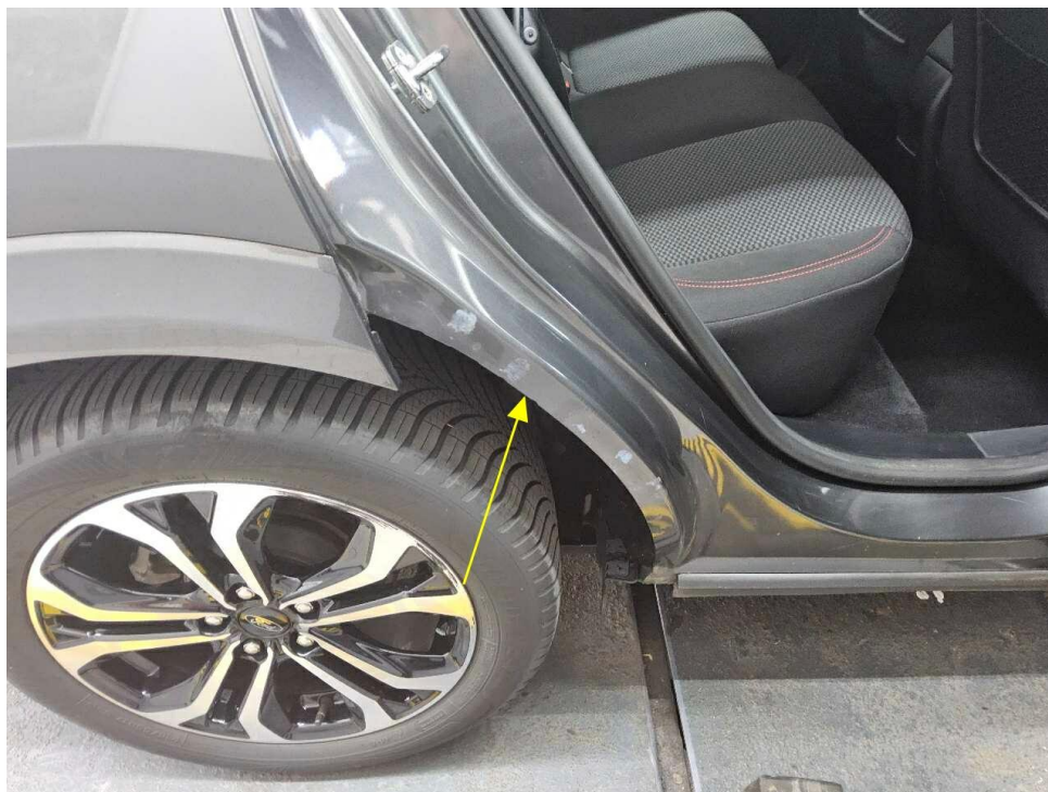
Bild 29 : Tür hinten rechts Einstieg Dichtung, zerstört
