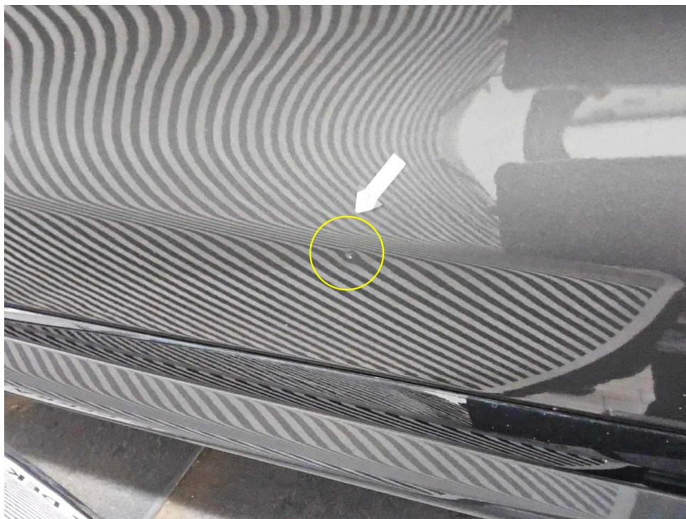
Bild 24 : Tür vorne links, eingedellt
