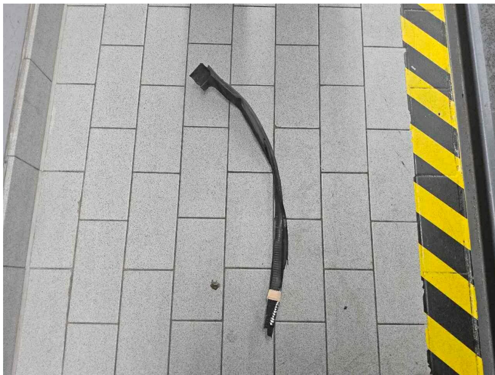
Bild 30 : Tür hinten rechts Einstieg Dichtung, zerstört
