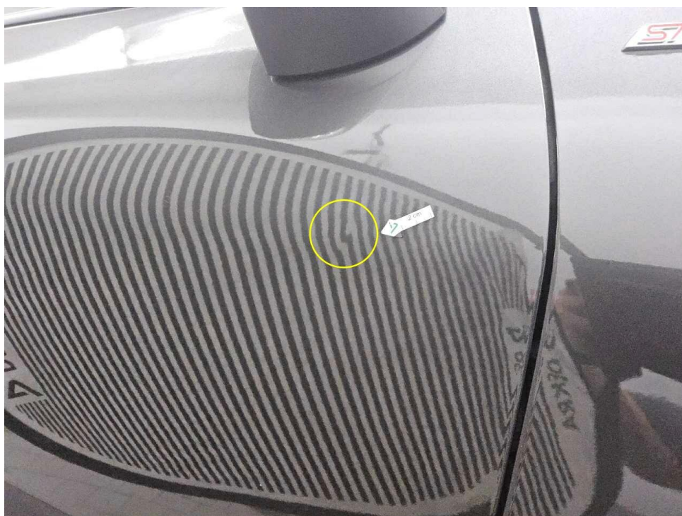
Bild 26 : Tür vorne rechts, eingedellt
