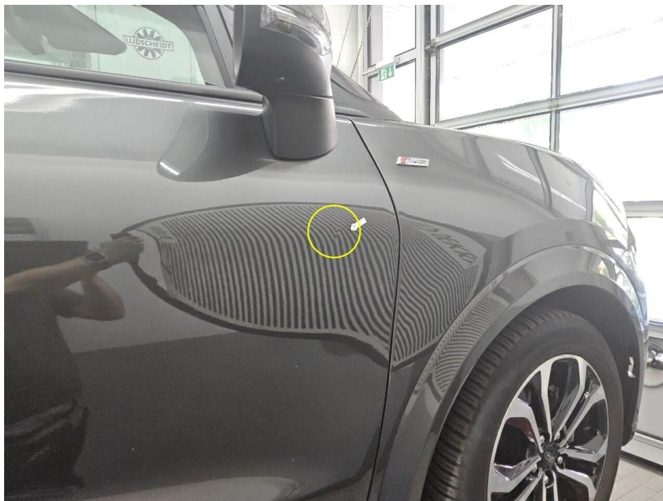
Bild 25 : Tür vorne rechts, eingedellt
