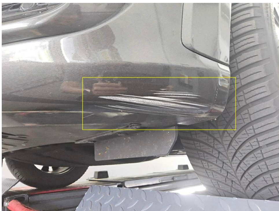
Bild 14 : Stoßfänger vorne Spoiler, zerkratzt
