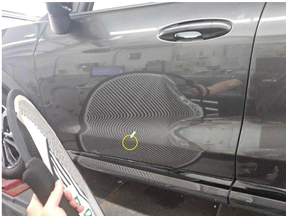
Bild 23 : Tür vorne links, eingedellt
