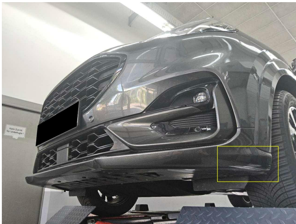
Bild 13 : Stoßfänger vorne Spoiler, zerkratzt
