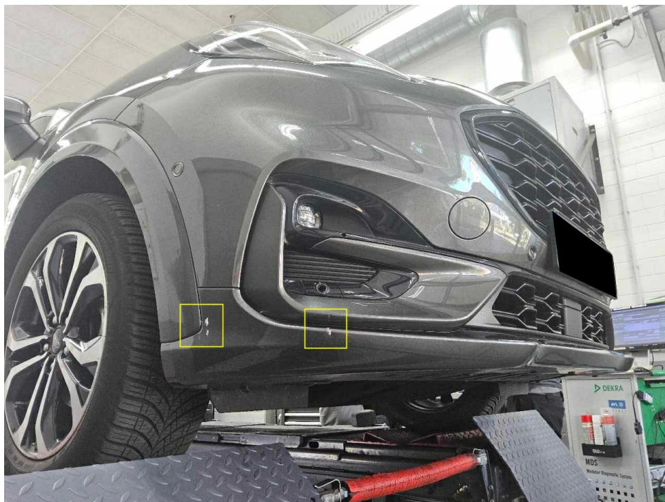
Bild 15 : Stoßfänger vorne Spoiler, zerkratzt
