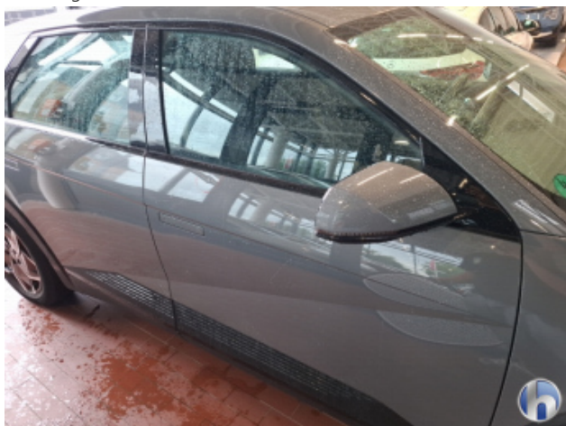
1. Tür Vorne - Rechts 1 Delle - Sanft Instandsetzen
