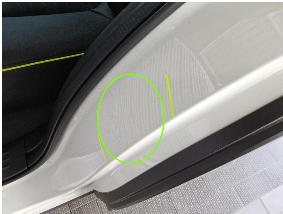
Bild 16 : Tür hinten links Einstieg, eingedellt, drücken
