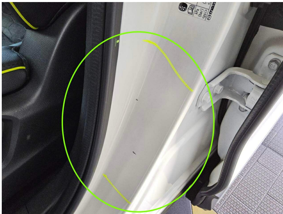
Bild 12 : Tür vorne links Einstieg, mehrfach eingedellt, smart repair
