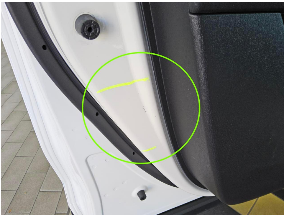
Bild 13 : Tür vorne links Lackierung, verschrammt, smart repair
