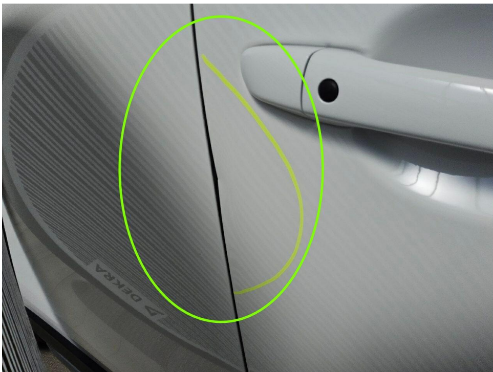
Bild 14 : Tür vorne rechts, verformt und verschrammt
