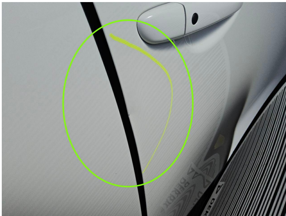
Bild 15 : Tür vorne rechts, verformt und verschrammt
