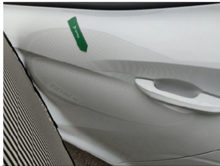
Tür / Hinten Links / Delle
