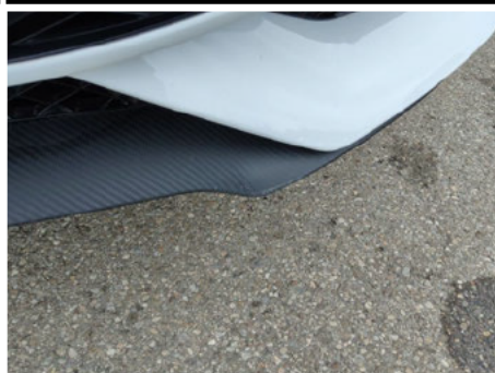
Spoiler / Vorne / Gebrochen
