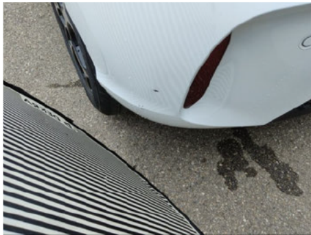
Stoßfänger / Hinten / Delle
