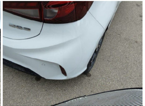
Stoßfänger / Hinten / Delle
