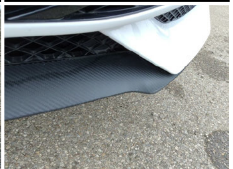
Spoiler / Vorne / Gebrochen
