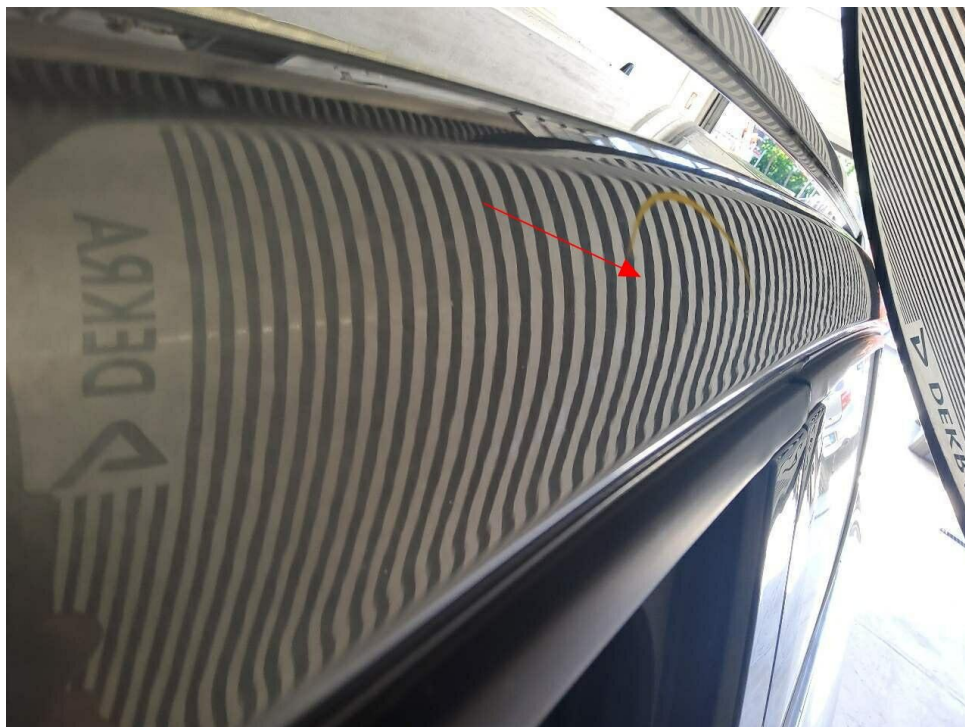
Bild 20 : Dachrahmen links, eingedellt
