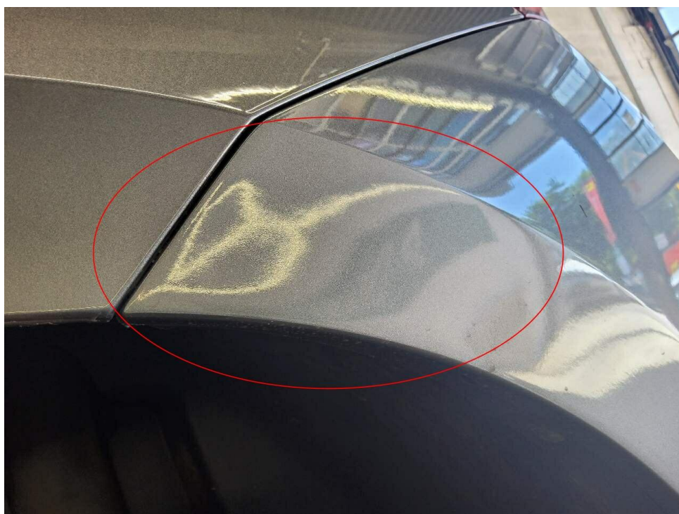
Bild 26 : Stoßfänger hinten, Reparaturspuren erkennbar (matte Lackoberfläche, Lackeinschlüsse)
