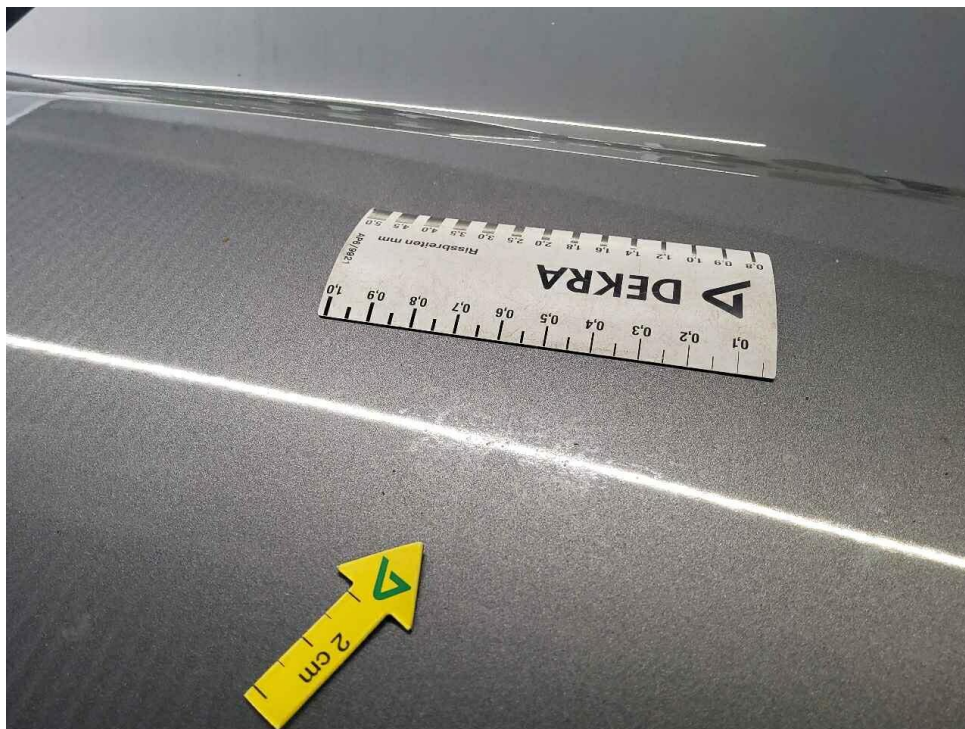
Bild 17 : Motorhaube, Lackierung, Umweltschaden
