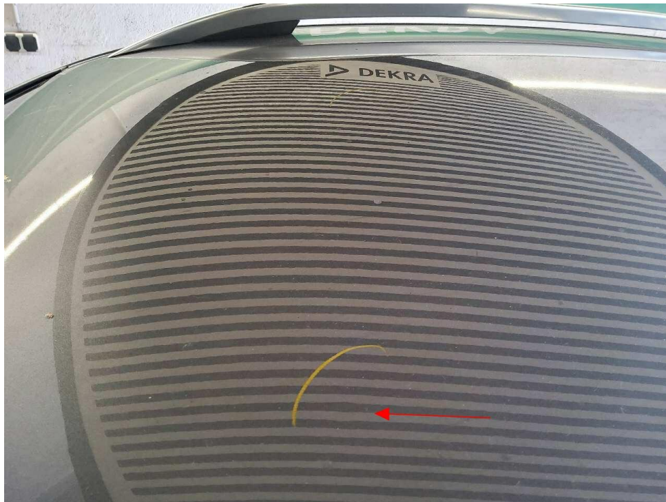
Bild 21 : Dach, mehrfach eingedellt
