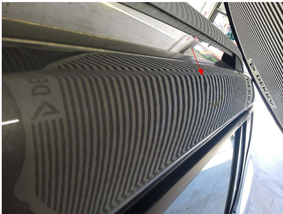
Bild 19 : Dachrahmen links, eingedellt
