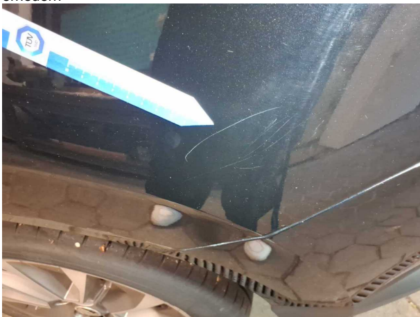
Beschädigung #4: Seitenwand links: Seitenwand - Kratzer - Smart Repair
