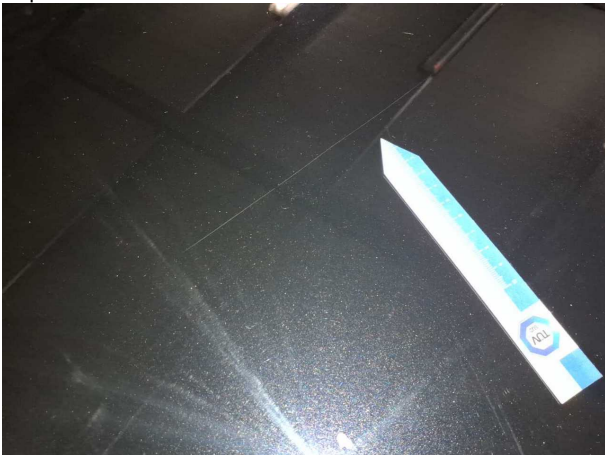
Beschädigung #1: Motor: Motorabdeckung - Kratzer - Smart Repair
