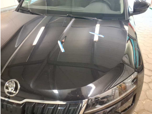
Beschädigung #1: Motor: Motorabdeckung - Kratzer - Smart Repair
