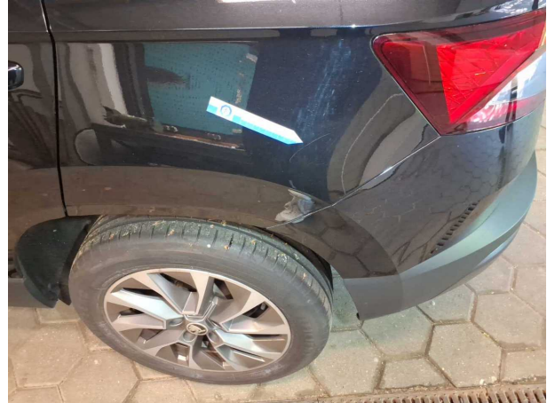
Beschädigung #4: Seitenwand links: Seitenwand - Kratzer - Smart Repair
