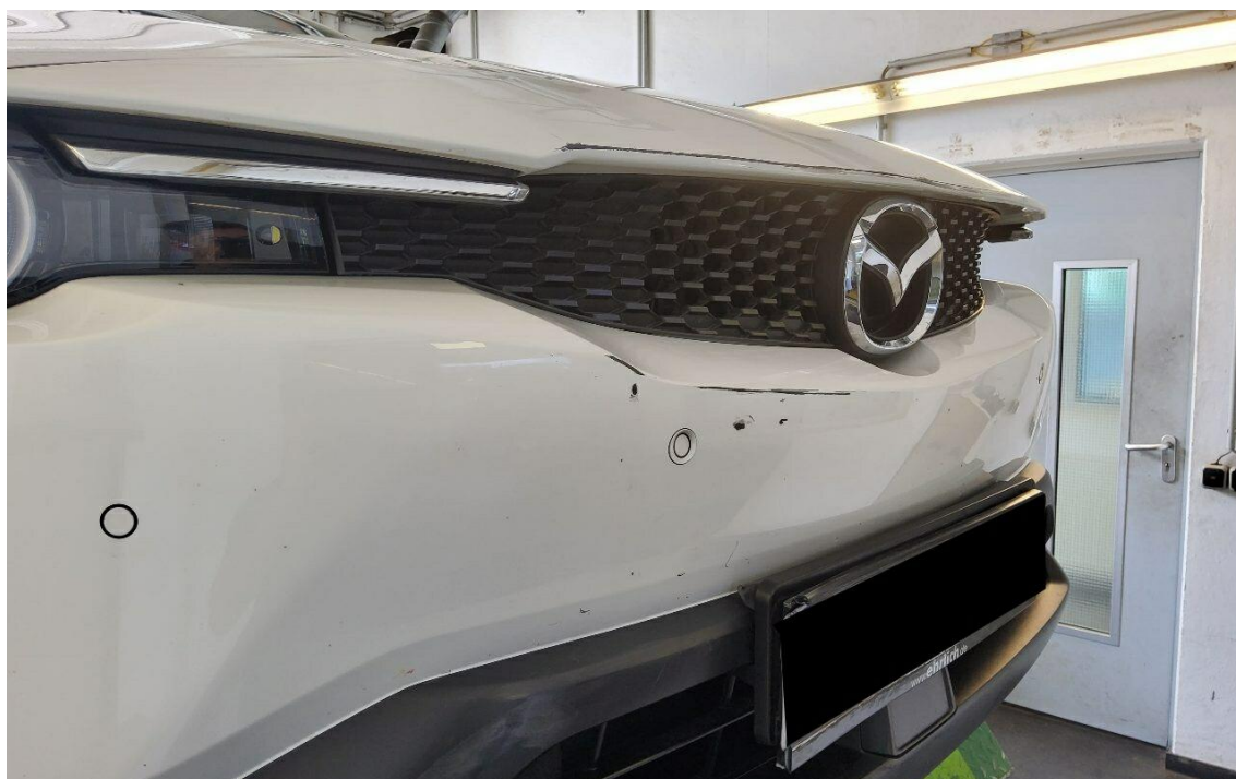
Bild 14 : Stoßfänger vorne, verschrammt
