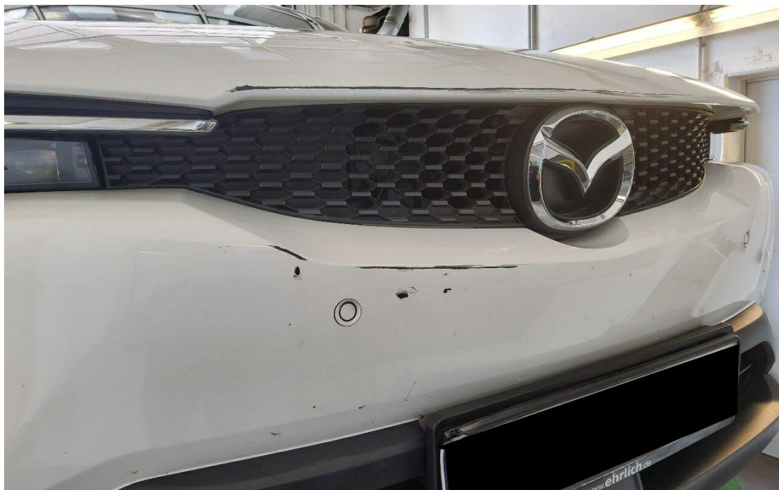
Bild 15 : Stoßfänger vorne, verschrammt
