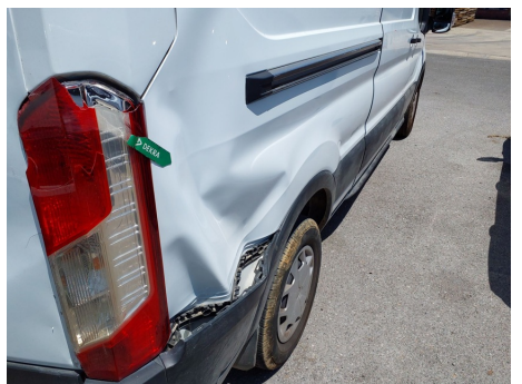
Aleta / Trasero Derecho / Abolladura
