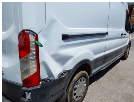
Aleta / Trasero Derecho / Abolladura
