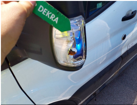
Piloto del intermitente / Izquierda / Roto
