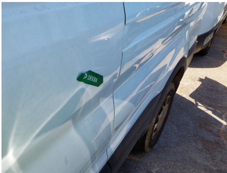
Panel lateral / Izquierda / Abolladura
