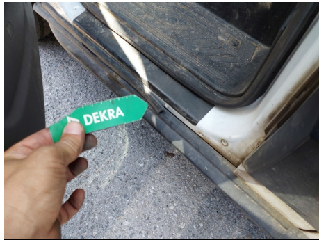
Junta de entrada de puerta / Delantero Izquierdo / Roto
