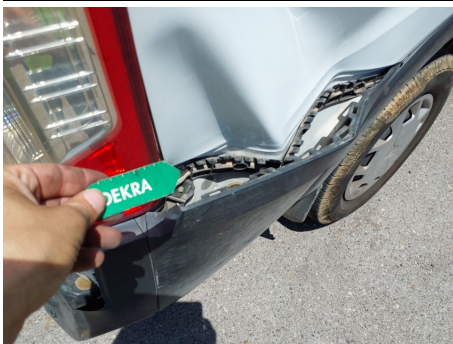
Soporte de paragolpes lateral / Trasero Derecho / Roto
