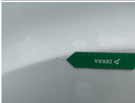
Kotflügel / Hinten Links / Rost
