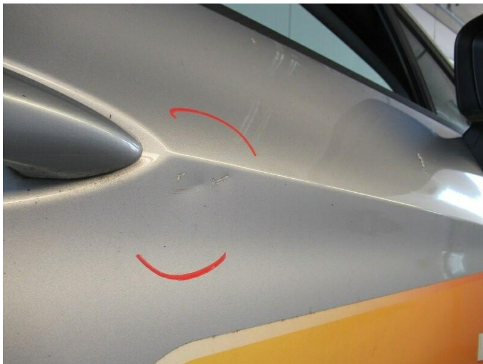
Bild 22 : Tür vorne rechts, deformiert, instandsetzen und lackieren mit Lackaufbau
