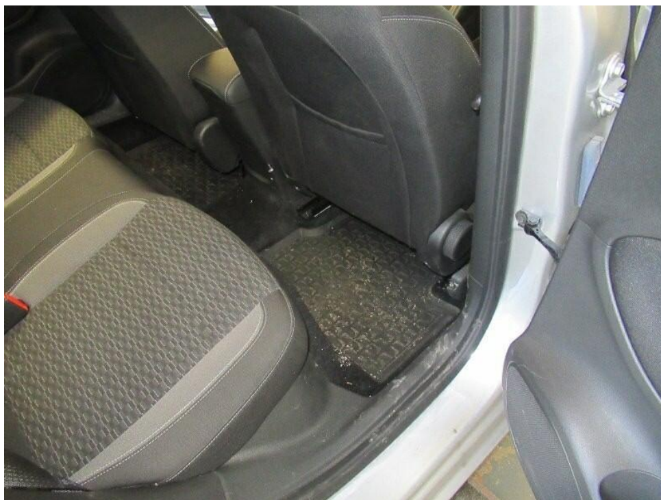
Bild 34 : Polster,Teppiche.Verkleidungen,..... stark verschmutzt. Geruch im Fahrzeug: Desinfektion und Ozonbehandlung.
