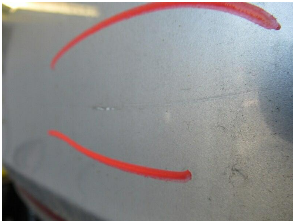
Bild 20 : Stoßfänger hinten Lackierung, zerkratzt, lackieren mit Lackaufbau
