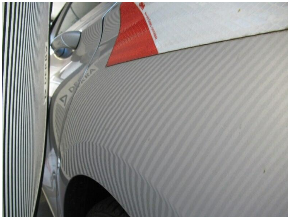
Bild 25 : Seitenteil hinten links, eingedellt, Gebrauchsspur
