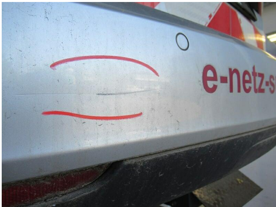
Bild 18 : Stoßfänger hinten Lackierung, zerkratzt, lackieren mit Lackaufbau
