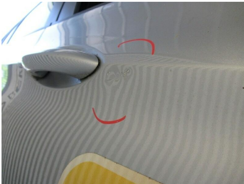
Bild 24 : Tür vorne rechts, deformiert, instandsetzen und lackieren mit Lackaufbau
