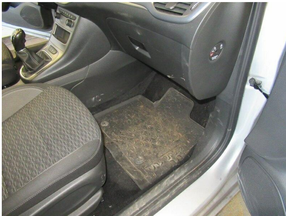
Bild 33 : Polster,Teppiche.Verkleidungen,..... stark verschmutzt. Geruch im Fahrzeug: Desinfektion und Ozonbehandlung.
