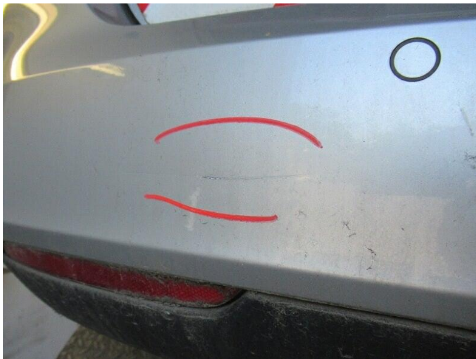
Bild 19 : Stoßfänger hinten Lackierung, zerkratzt, lackieren mit Lackaufbau
