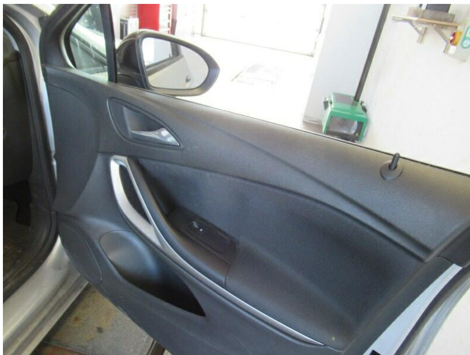
Bild 32 : Polster, Teppiche, Verkleidungen, ..... stark verschmutzt. Geruch im Fahrzeug: Desinfektion und Ozonbehandlung.
