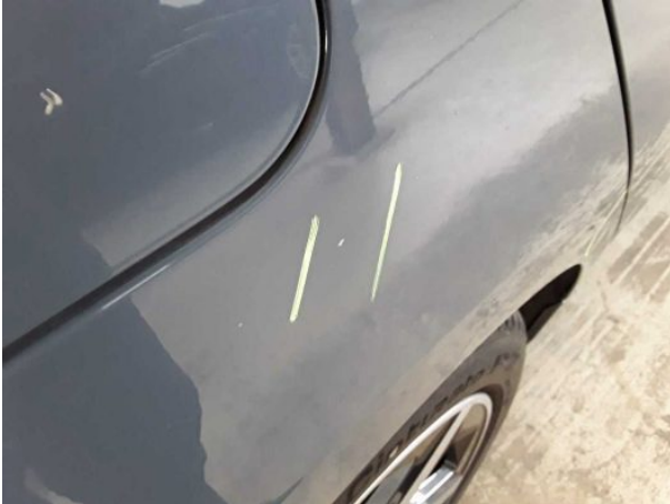
Beschädigung #7: Seitenwand rechts: Seitenwand - Delle / Lackschaden - Smart Repair
