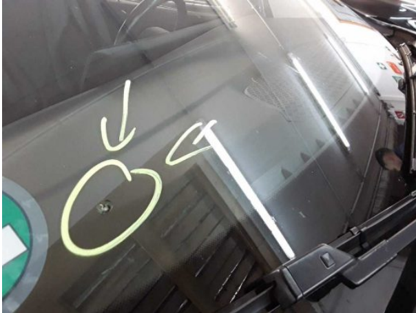
Beschädigung #9: Verglasung: Frontscheibe (Rissbildung) - Steinschlag - erneuern
