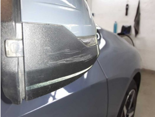
Beschädigung #4: Außenspiegel links: Spiegelgehäuse - verkratzt / verschürft - Wertminderung
