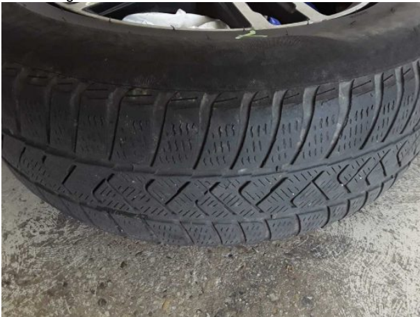
Beschädigung #1: 2.Radsatz: Reifensatz komplett - verschlissen - kein Abzug
