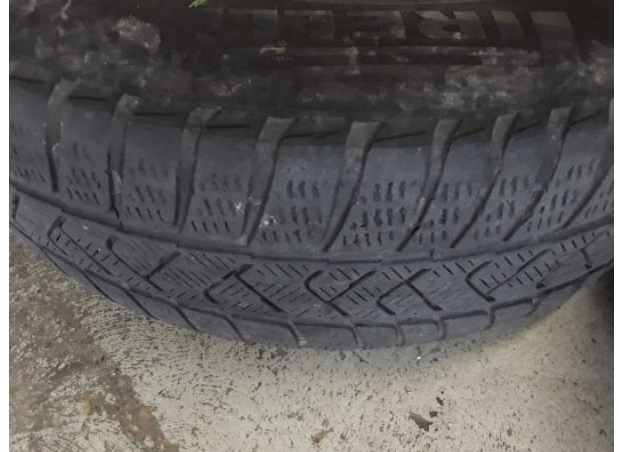
Beschädigung #1: 2.Radsatz: Reifensatz komplett - verschlissen - kein Abzug
