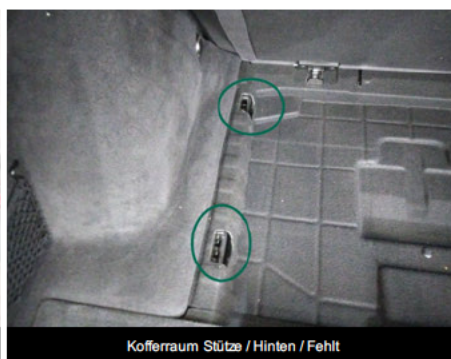
Kofferraum Stütze / Hinten / Fehlt
