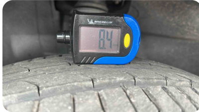
Photo de la mesure de l'usure du pneu avant gauche
