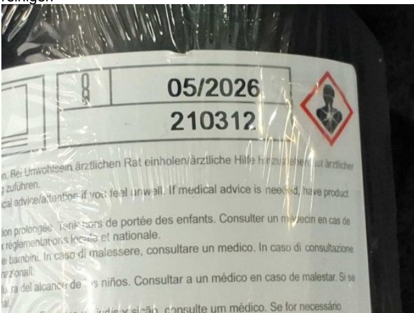
Beschädigung #3: Ausrüstung: Tirefit Füllmittel - abgelaufen - erneuern
