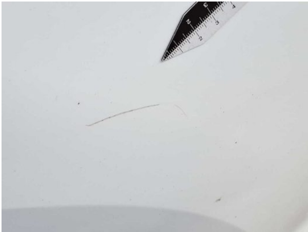
Beschädigung #12: Tür hinten rechts: Tür - Kratzer - instandsetzen und lackieren
