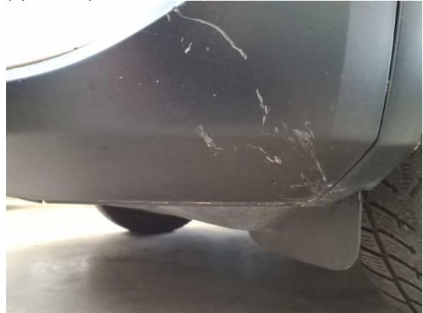
Beschädigung #5: Stossfänger vorn: Stossfänger vorn links (Spoilerecke) - verkratzt / verschürft - erneuern
