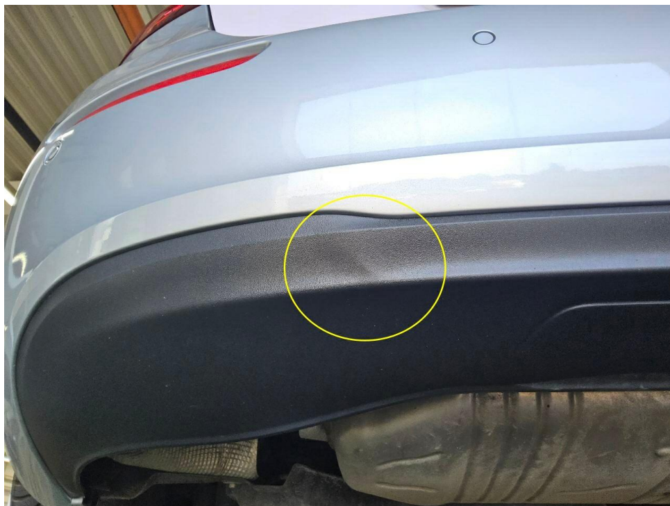
Bild 19 : Stoßfänger hinten, Heckschürze unterhalb, deformiert
