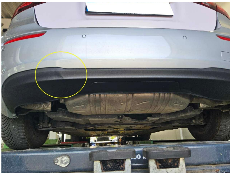
Bild 20 : Stoßfänger hinten, Heckschürze unterhalb, deformiert
