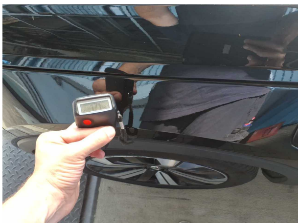
Nachlackierung 1: Kotflügel links, Tür hinten links, Tür vorne links
