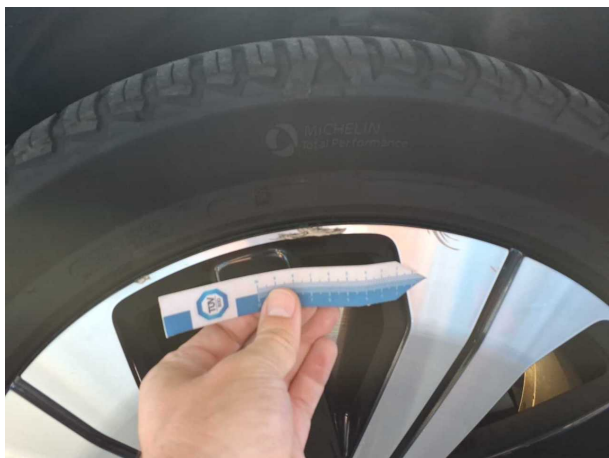
Beschädigung #4: Rad/Reifen: Leichtmetallfelge vorn links (Materialabtrag zu groß/tief, Sicherheitsrelevant) - beschädigt -
