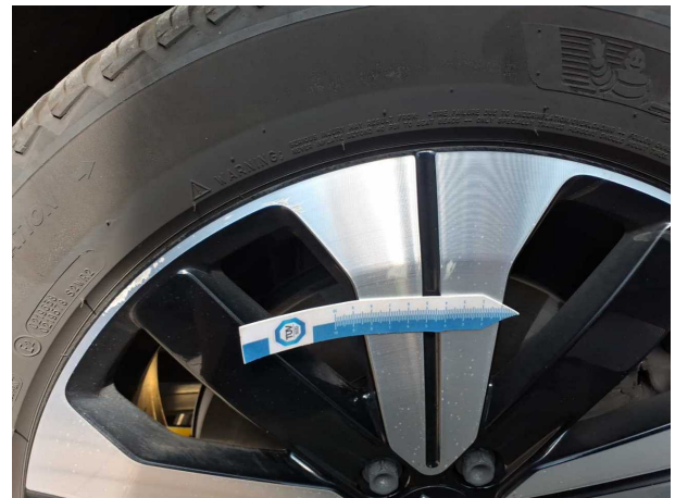
Beschädigung #3: Rad/Reifen: Leichtmetallfelge vorn rechts (Optischer Mangel) - verkratzt / verschürft - Wertminderung
