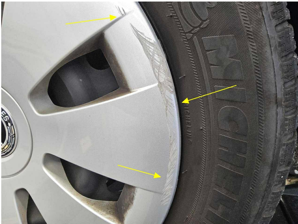
Bild 20 : Radzierblende vorne links verschrammt
