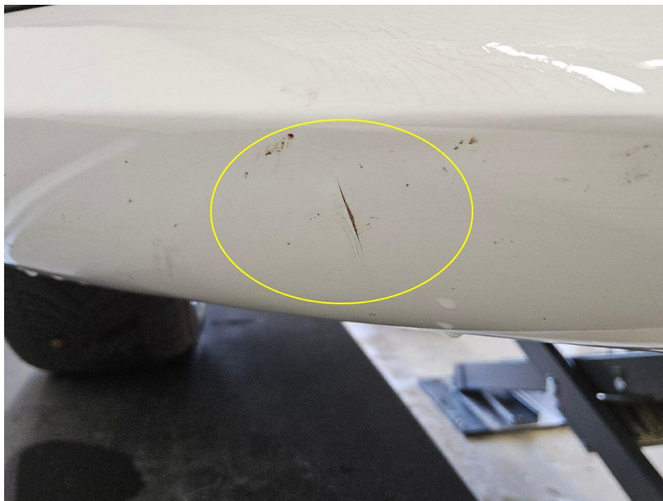
Bild 26 : Frontspoiler Lackierung, gerissen, lackieren mit Lackaufbau
