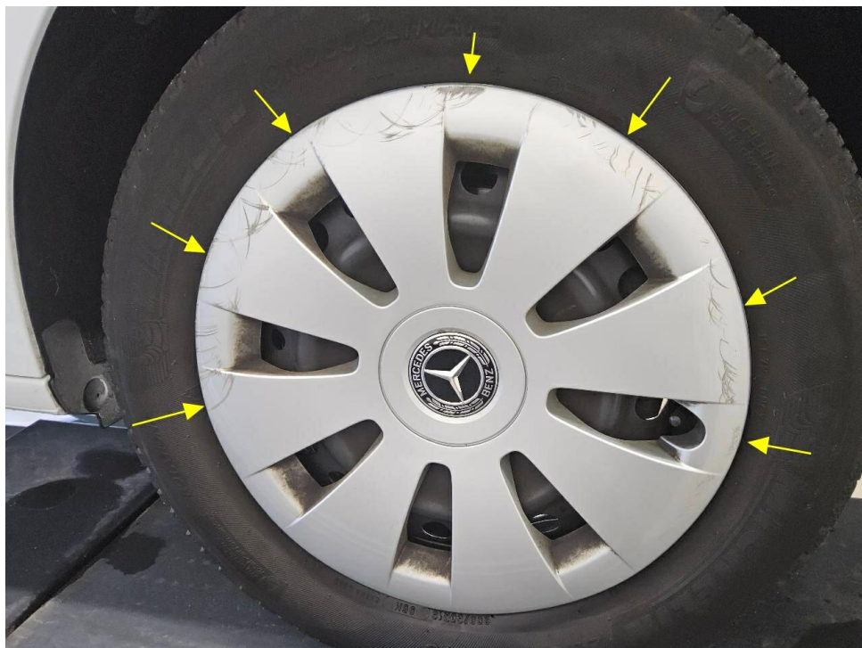
Bild 22 : Radzierblende vorne rechts verschrammt
