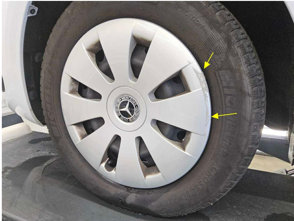
Bild 21 : Radzierblende vorne links verschrammt
