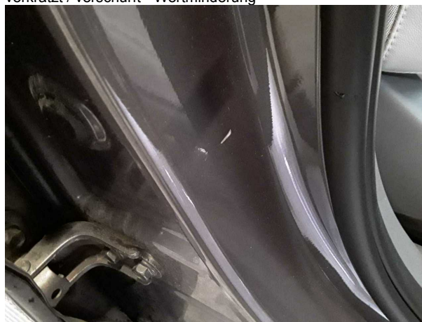
Beschädigung #5: Schweller rechts: Einstieg - Delle / Lackschaden - Smart Repair
