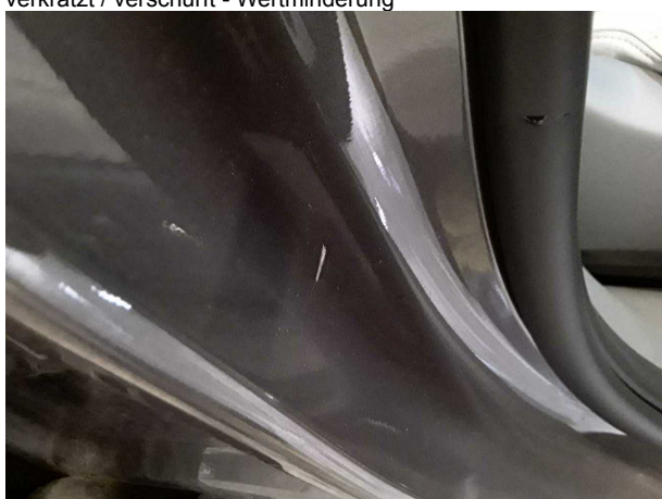
Beschädigung #5: Schweller rechts: Einstieg - Delle / Lackschaden - Smart Repair
