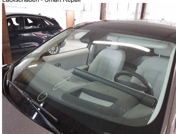
Beschädigung #6: Verglasung: Frontscheibe (Rissbildung) - Steinschlag - erneuern
