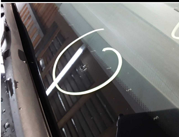
Beschädigung #6: Verglasung: Frontscheibe (Rissbildung) - Steinschlag - erneuern
