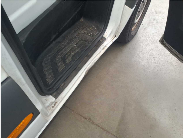
Beschädigung #17: Seitenwand rechts: Einstieg - verformt - instandsetzen/lackieren (S2)
