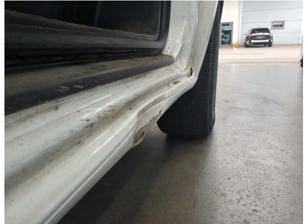
Beschädigung #17: Seitenwand rechts: Einstieg - verformt - instandsetzen/lackieren (S2)
