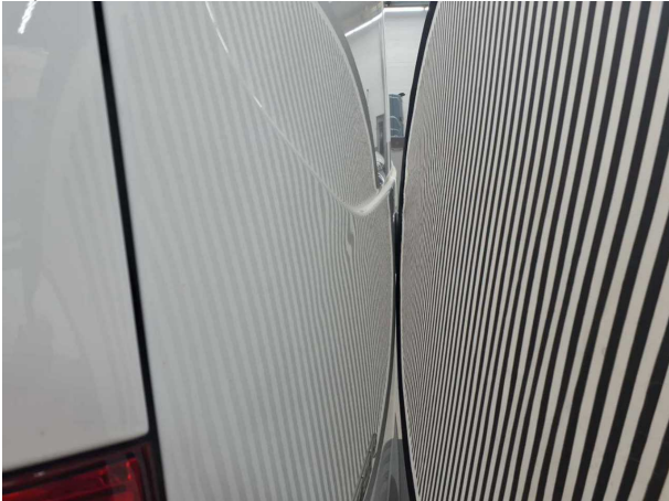
Beschädigung #10: Heckklappe/-tür: Hecktür links - Delle(n) - Smart Repair
