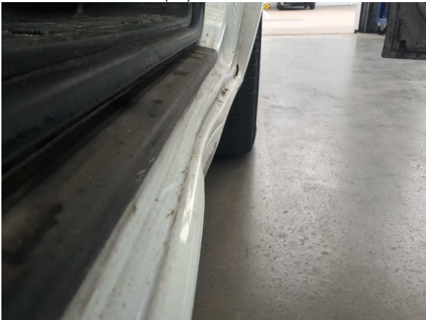
Beschädigung #17: Seitenwand rechts: Einstieg - verformt - instandsetzen/lackieren (S2)
