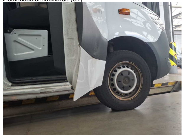
Beschädigung #22: Tür vorn rechts: Tür - verformt - erneuern
