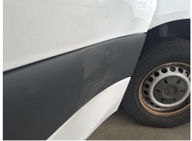
Beschädigung #2: Tür vorn rechts: Zierleiste unten - verkratzt / verschürft - erneuern
