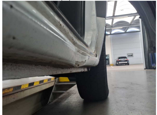
Beschädigung #17: Seitenwand rechts: Einstieg - verformt - instandsetzen/lackieren (S2)
