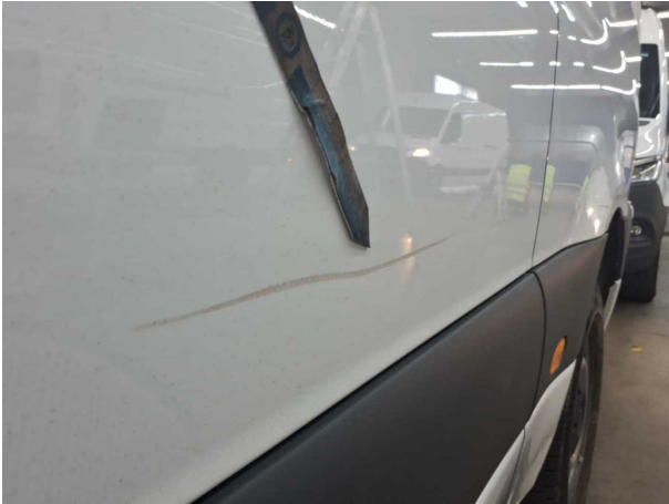
Beschädigung #18: Seitenwand links: Seitenwand (Vorn) - Delle / Lackschaden - instandsetzen und lackieren
