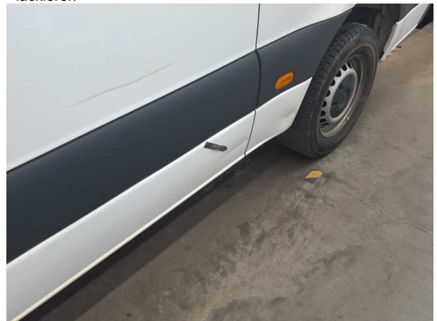
Beschädigung #13: Seitenwand links: Seitenwand (Bepunktung unten vorne) - verformt - instandsetzen und lackieren
