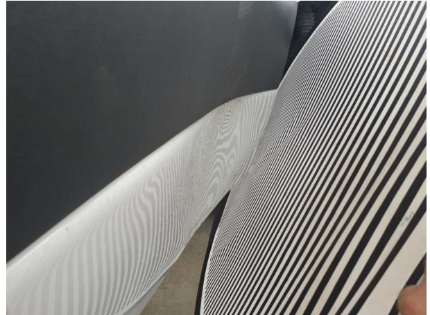
Beschädigung #22: Tür vorn rechts: Tür - verformt - erneuern
