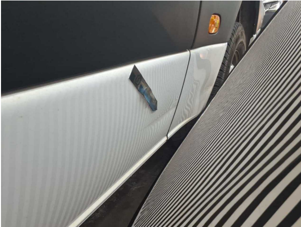
Beschädigung #13: Seitenwand links: Seitenwand (Bepankung unten vorne) - verformt - instandsetzen und lackieren
