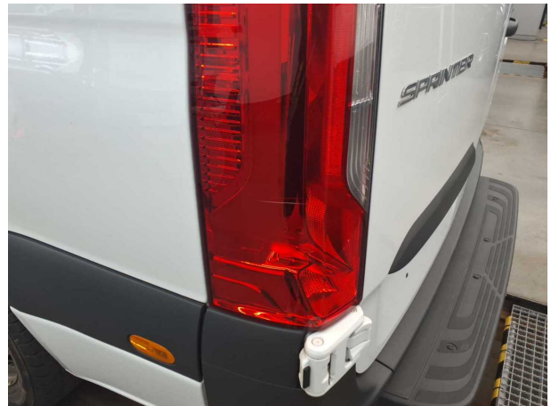
Beschädigung #6: Heckleuchte: Heckleuchte links - verkratzt / verschürft - erneuern
