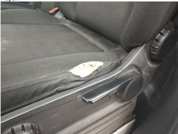
Beschädigung #12: Sitz vorn: Sitzbezug links - gebrochen / gerissen - erneuern
