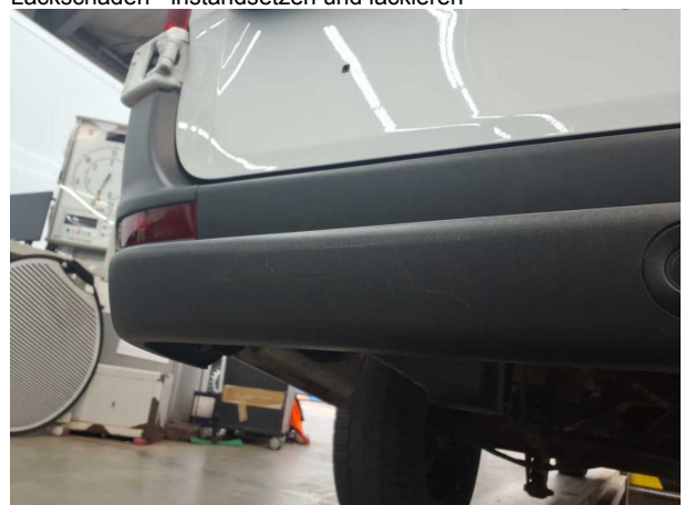
Beschädigung #20: Stossfänger hinten: Stossfänger Auftritt mit Parktronic (komplett) - verformt - erneuern
