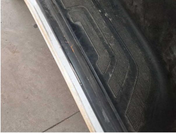
Beschädigung #1: Karosserie: Türdichtung vorn links - gebrochen / gerissen - erneuern
