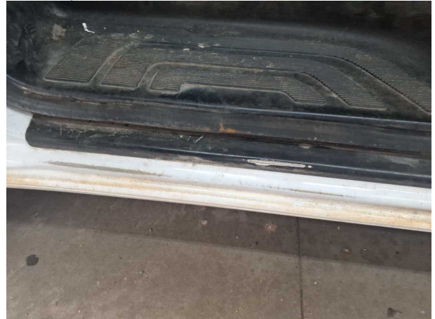
Beschädigung #11: Schweller links: Einstieg - verkratzt / versch... - lackieren
