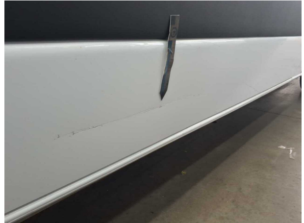
Beschädigung #21: Schiebetür rechts: Schiebetür - verformt - instandsetzen/lackieren (S1)
