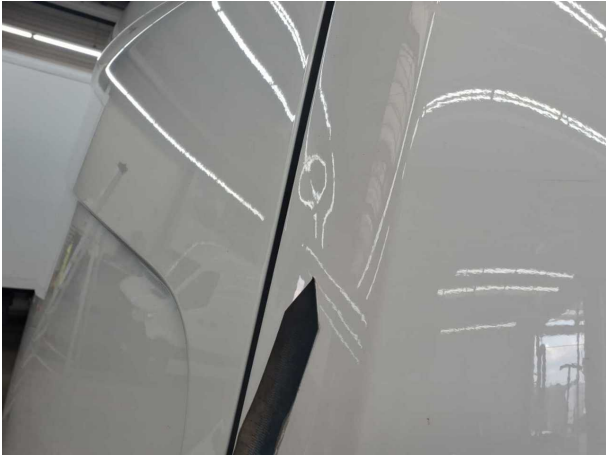
Beschädigung #8: Karosserie: Eckbeplankung rechts - Delle(n) - Smart Repair
