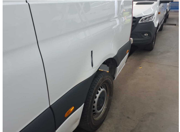
Beschädigung #19: Seitenwand links: Seitenwand - Delle / Lackschaden - instandsetzen und lackieren
