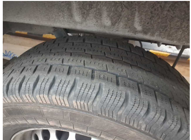
Beschädigung #7: Rad/Reifen: Reifen hinten links - verschlissen - erneuern
