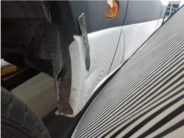
Beschädigung #14: Seitenwand rechts: Seitenwand (Bepankung unten vorne) - verformt - instandsetzen und lackieren
