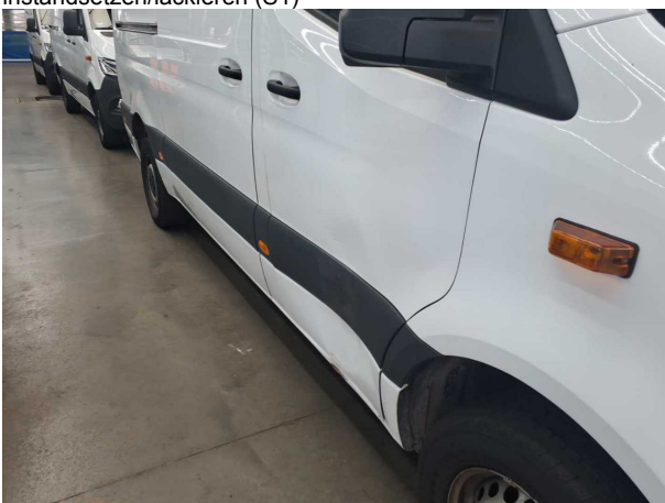
Beschädigung #22: Tür vorn rechts: Tür - verformt - erneuern
