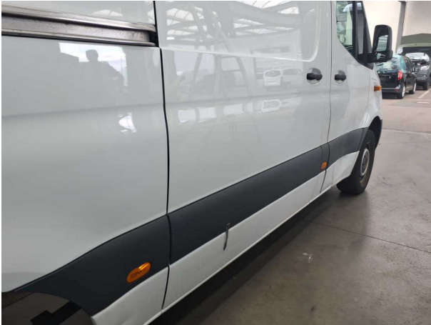
Beschädigung #21: Schiebetür rechts: Schiebetür - verformt - instandsetzen/lackieren (S1)
