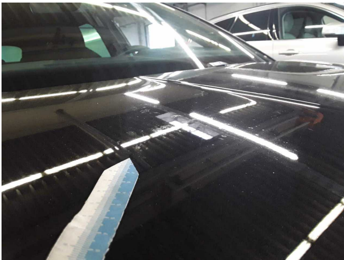
Damage 6: Bonnet: Bonnet (Anätzung) - Paint defect - Paint
