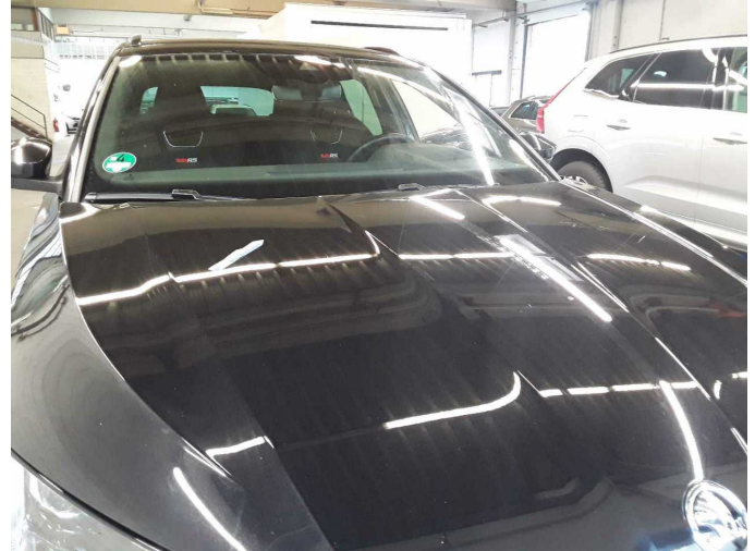
Damage 6: Bonnet: Bonnet (Anätzung) - Paint defect - Paint
