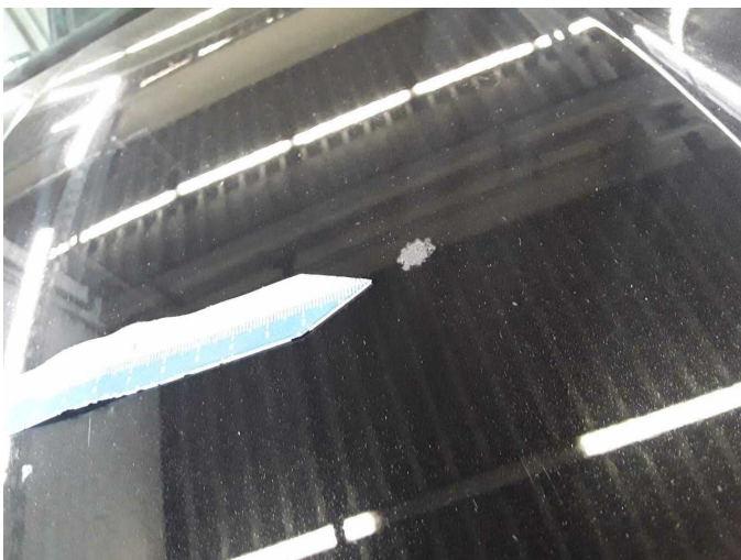
Damage 6: Bonnet: Bonnet (Anätzung) - Paint defect - Paint
