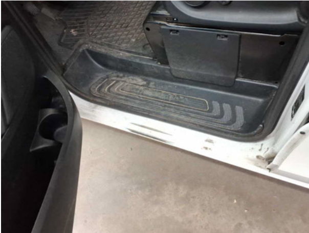
Beschädigung #9: Schweller links: Einstieg - verkratzt / verschürft - lackieren
