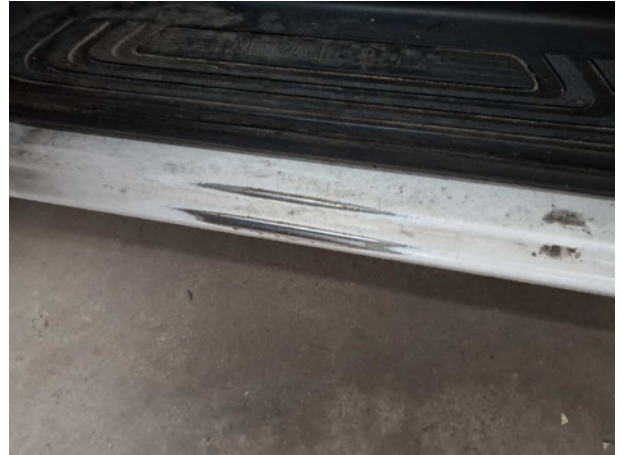
Beschädigung #9: Schweller links: Einstieg - verkratzt / verschürft - lackieren
