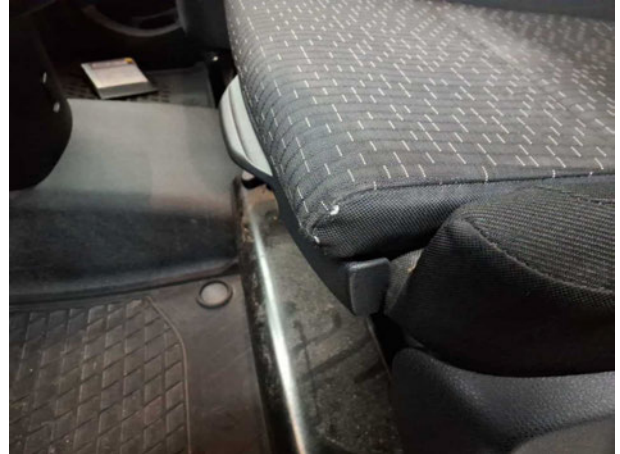
Beschädigung #2: Sitz vorn: Sitzbezug links - gebrochen / gerissen - Smart Repair
