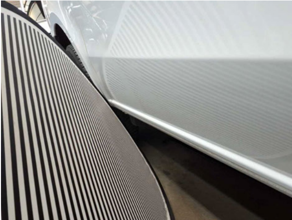
Beschädigung #14: Schiebetür rechts: Schiebetür - nicht fachgerecht instandgesetzt - instandsetzen/lackieren (S1)
