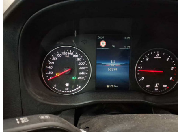
Beschädigung #6: elektronische Systeme: elektronische Systeme (RDKS) - leuchtet - Diagnose durchführen
