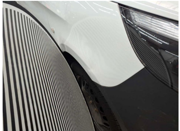
Beschädigung #12: Kotflügel rechts: Kotflügel rechts - verformt - erneuern
