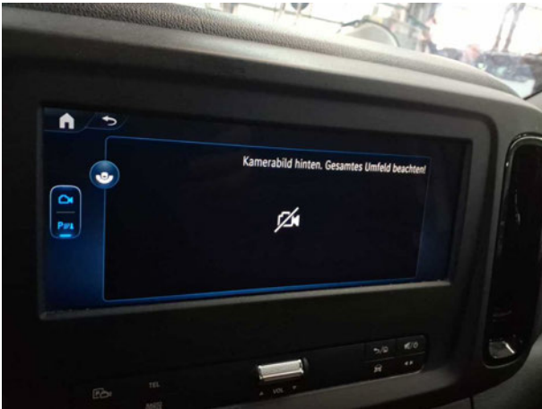
Beschädigung #7: elektronische Systeme: Rückfahrkamera - ohne Funktion - Diagnose durchführen
