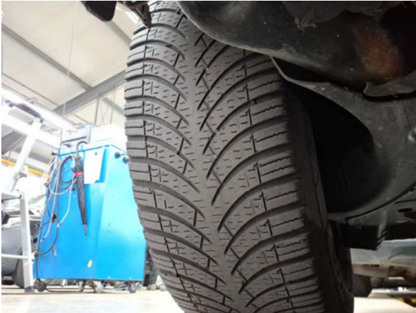
Beschädigung #10: Rad/Reifen: Reifen hinten - verschlissen - erneuern
