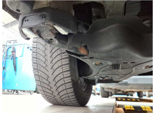
Beschädigung #15: Hinterachse: Querlenker rechts (inkl. Abdeckung) - verformt - erneuern
