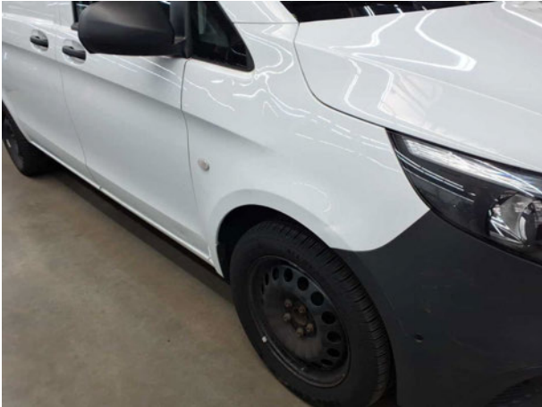
Beschädigung #12: Kotflügel rechts: Kotflügel rechts - verformt - erneuern
