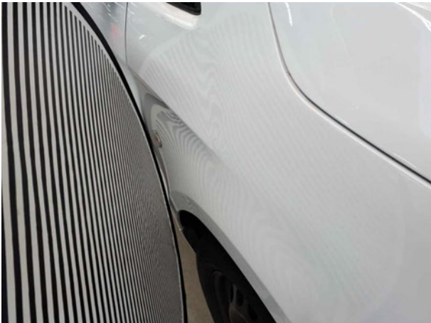
Beschädigung #12: Kotflügel rechts: Kotflügel rechts - verformt - erneuern
