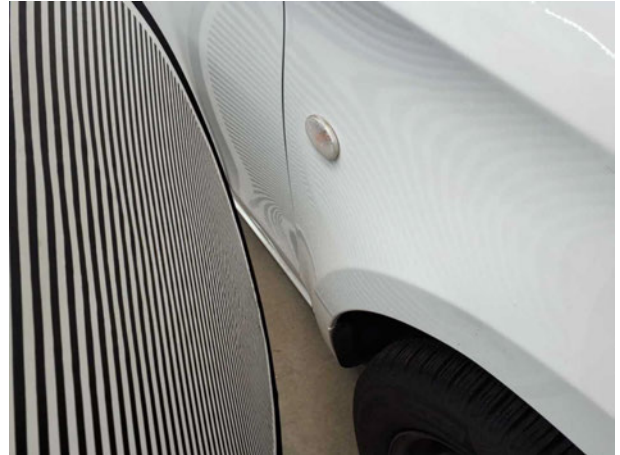
Beschädigung #12: Kotflügel rechts: Kotflügel rechts - verformt - erneuern
