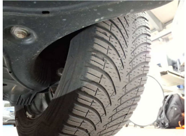
Beschädigung #10: Rad/Reifen: Reifen hinten - verschlissen - erneuern
