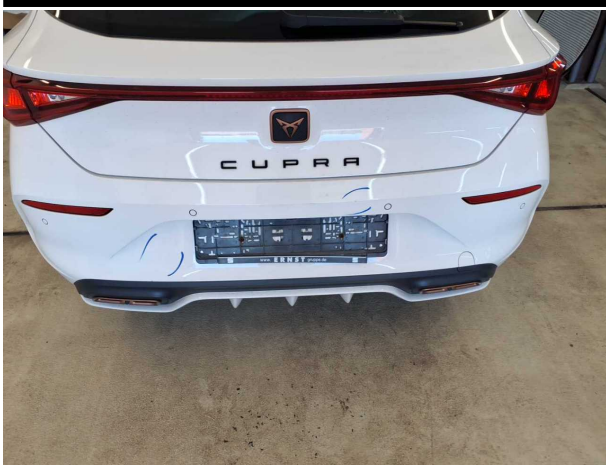
Beschädigung #7: Stossfänger hinten: Stossfänger hinten - verkratzt / verschürft - instandsetzen und lackieren
