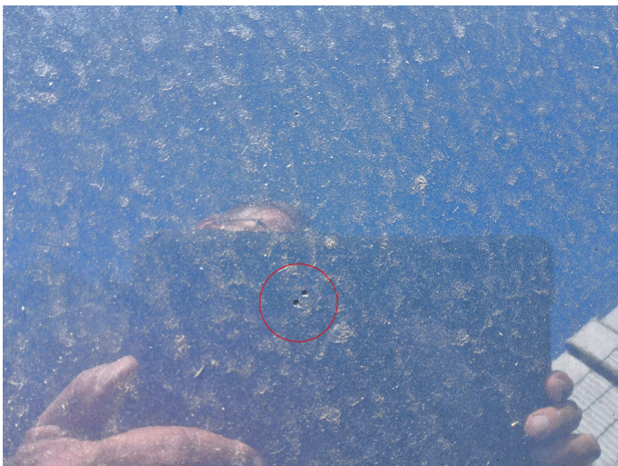
Bild 3: Außen, Motorhaube - Lackierung, Steinschlag, lackieren
