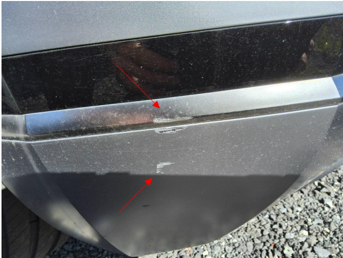
Bild 1: Außen, Heckschürze hinten unten, verschrammt, erneuern
