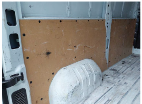
Garniture de panneau / Arrière Gauche / Cassé
