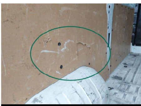
Garniture de panneau / Arrière Gauche / Cassé
