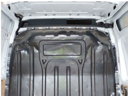
Panneau séparation cabine / - / Enfoncement
