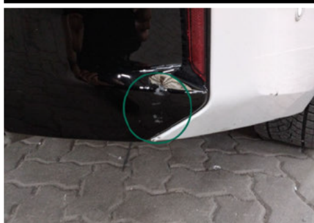
Stoßfänger unterhalb / Hinten / Kratzer
