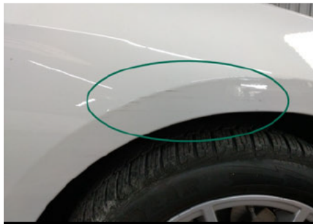
Kotflügel / Vorne Rechts / Kratzer
