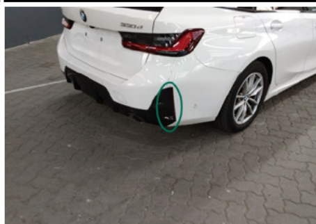
Stoßfänger unterhalb / Hinten / Kratzer
