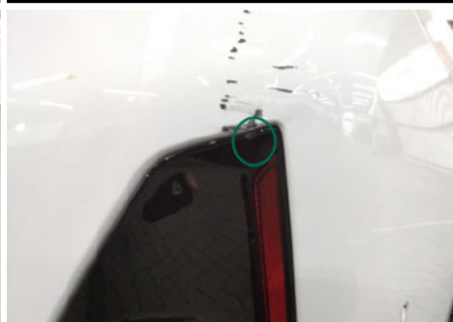
Stoßfänger unterhalb / Hinten / Kratzer
