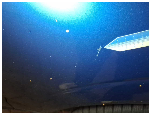
Beschädigung #7: Kotflügel rechts: Kotflügel rechts - Lackmangel - Smart Repair
