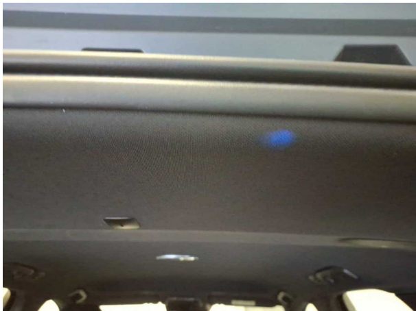
Beschädigung #2: Verkleidungen/Abdeckungen: Dachhimmel - verschmutzt - reinigen
