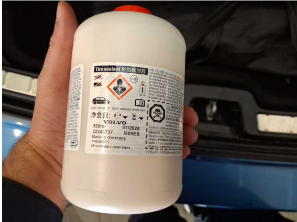
Beschädigung #1: Ausrüstung: Tirefit Füllmittel - abgelaufen - erneuern
