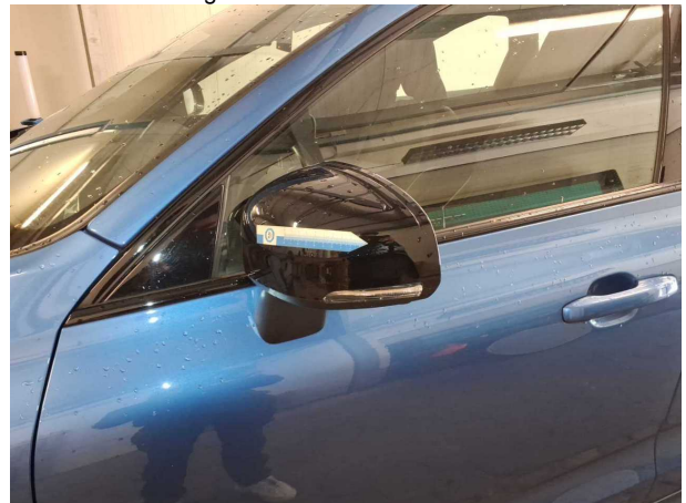
Beschädigung #3: Außenspiegel links: Abdeckkappe - verkratzt / verschürft - Smart Repair
