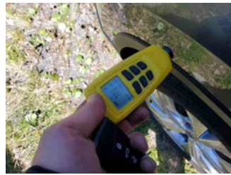
Lackstärke Seitenwand hinten rechts
