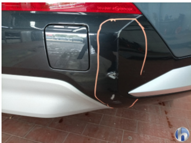
2. Stoßfänger Hinten Unfallschaden - Erneuern
