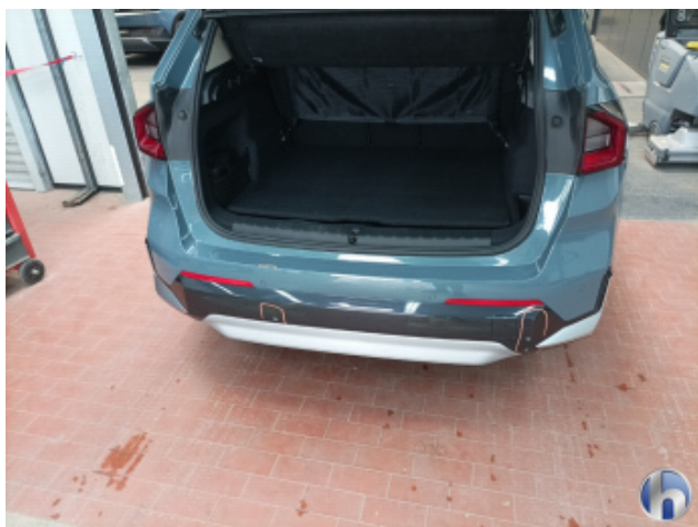
2. Stoßfänger Hinten Unfallschaden - Erneuern
