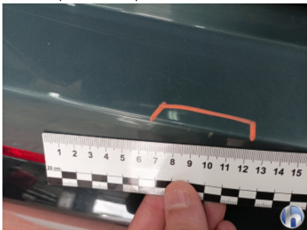
2. Stoßfänger Hinten Unfallschaden - Erneuern
