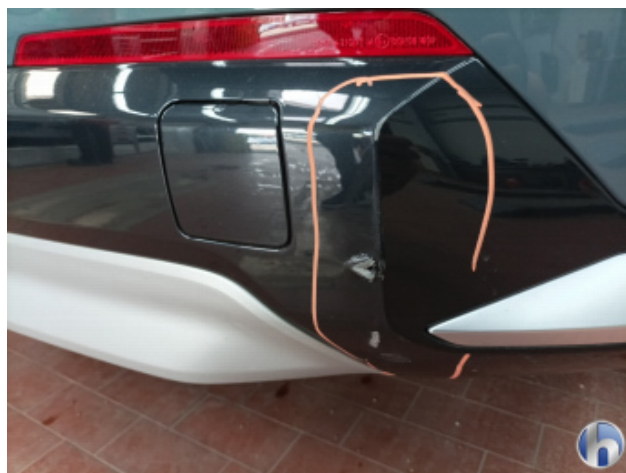
2. Stoßfänger Hinten Unfallschaden - Erneuern
