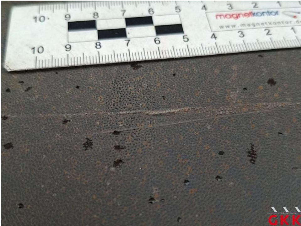
Bild 21. Stoßfänger hinten, Verkleidung -unlackiert-, beschädigt, ersetzen
