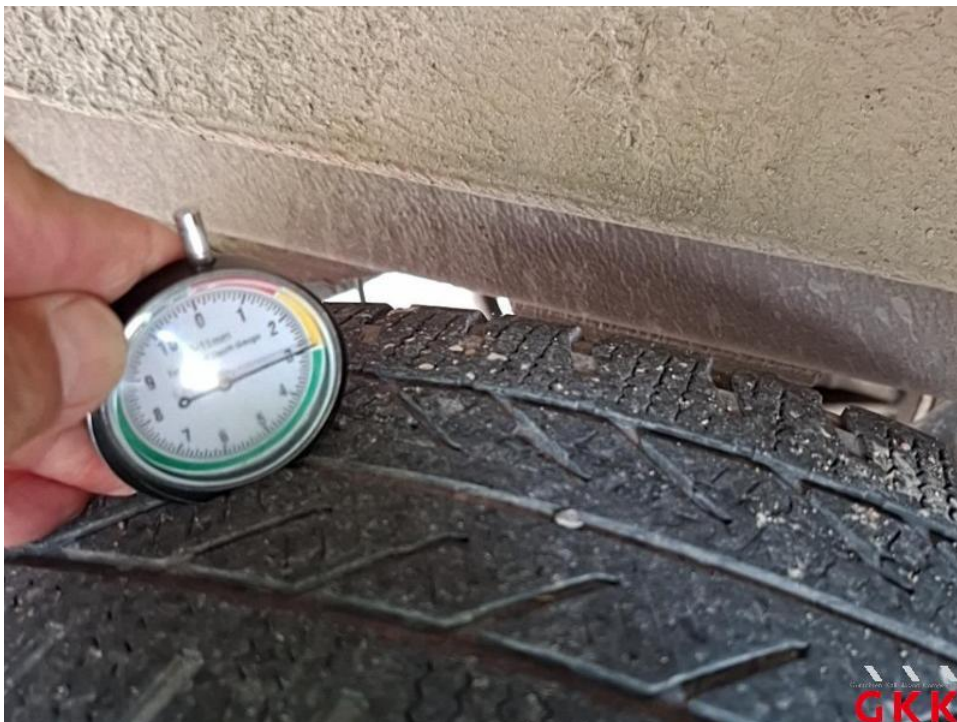
Bild 52. Satz Sommerreifen fehlt - falsche Reifenart, teilweise Untermaß, ersetzen
