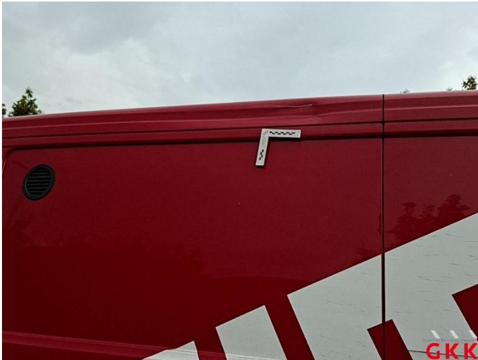
Bild 32. Dach, Mitte, beschädigt, instand setzen - lackieren
