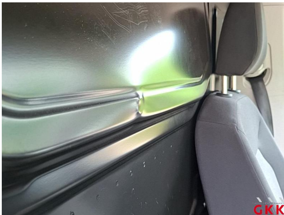
Bild 16. Trennwand, beschädigt, instand setzen - lackieren
