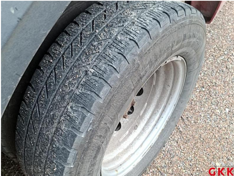
Bild 50. Satz Sommerreifen fehlt - falsche Reifenart, teilweise Untermaß, ersetzen
