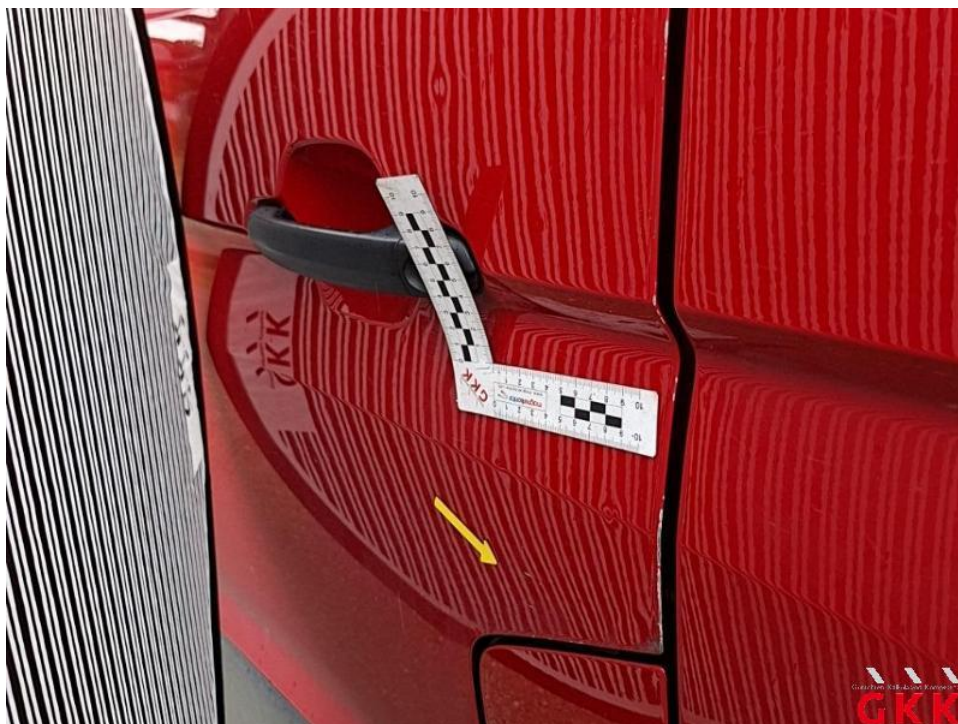
Bild 36. Tür vorne links, beschädigt, instand setzen - lackieren
