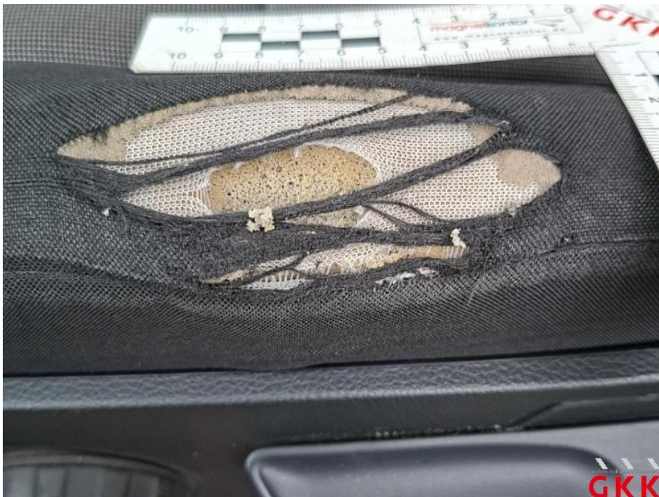
Bild 46. Sitz vorne links, Bezug Sitzkissen -Stoff-, gerissen, ersetzen
