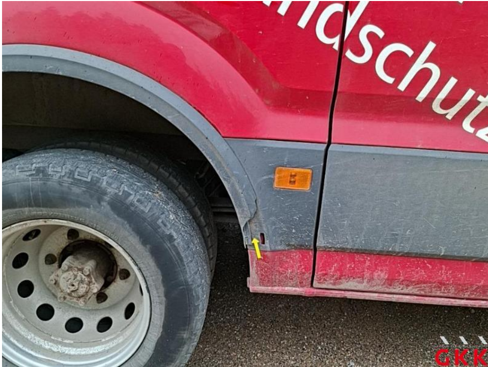
Bild 17. Seitenwand rechts, Leiste, Radlauf, beschädigt, ersetzen
