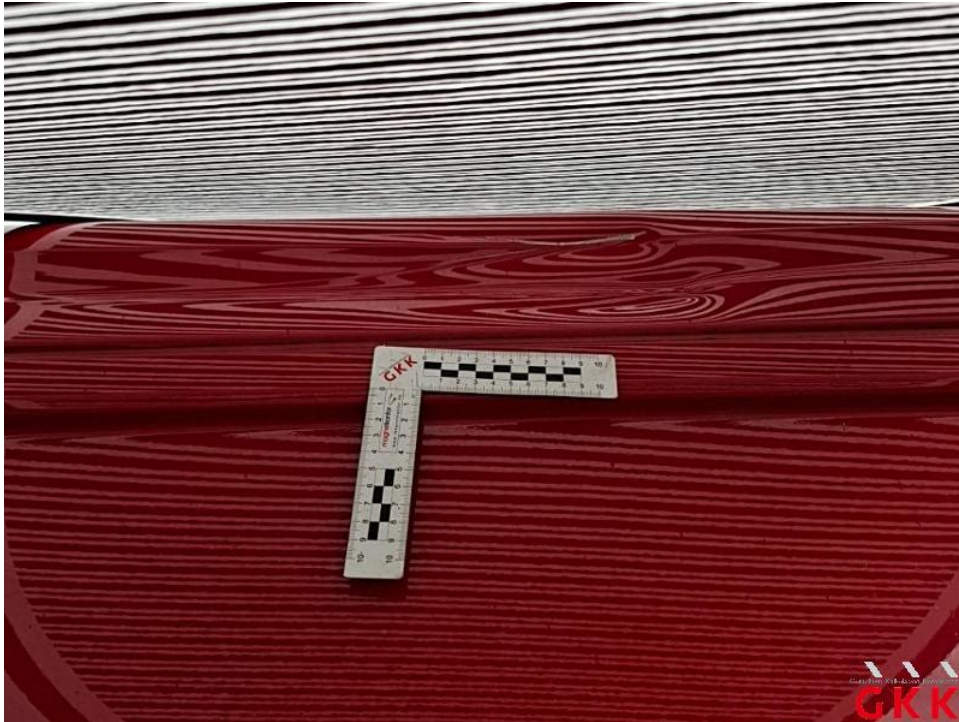
Bild 33. Dach, Mitte, beschädigt, instand setzen - lackieren
