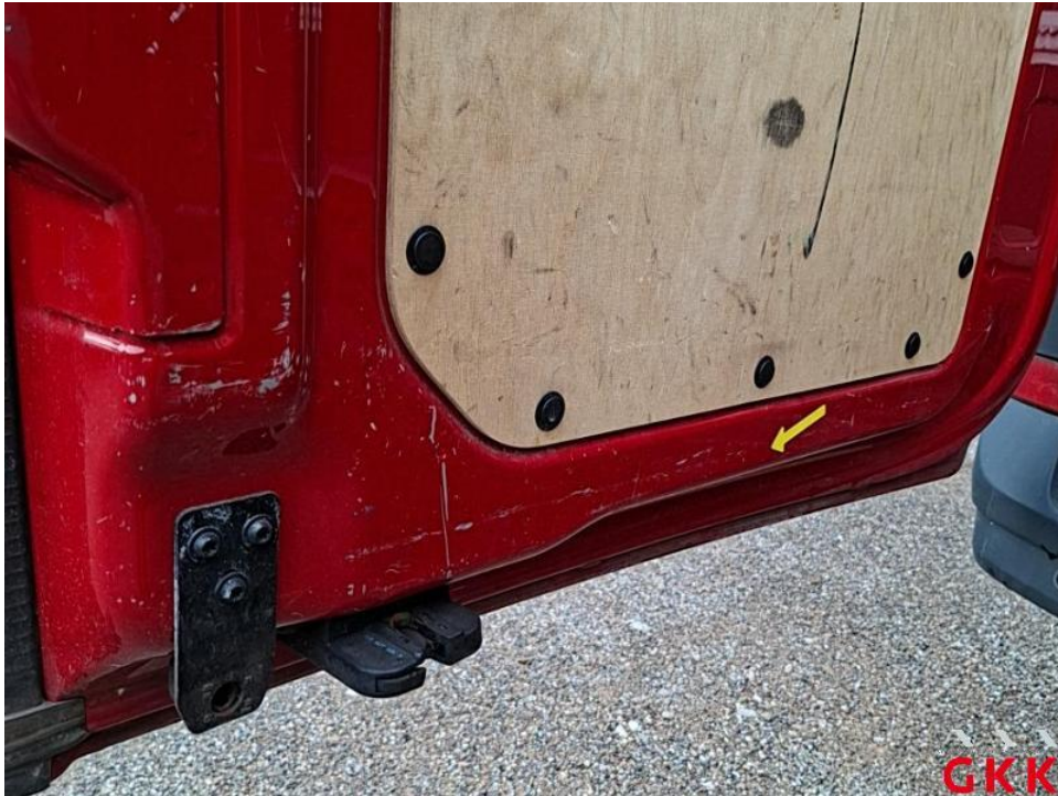
Bild 31. Hecktür links, innen, beschädigt, instand setzen - lackieren
