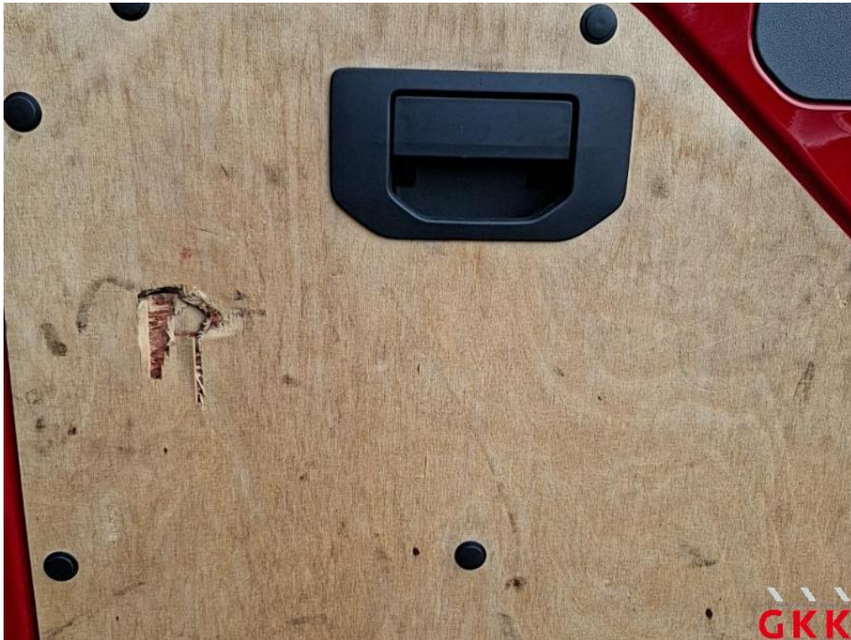
Bild 24. Hecktür rechts, Innenverkleidung, beschädigt, ersetzen
