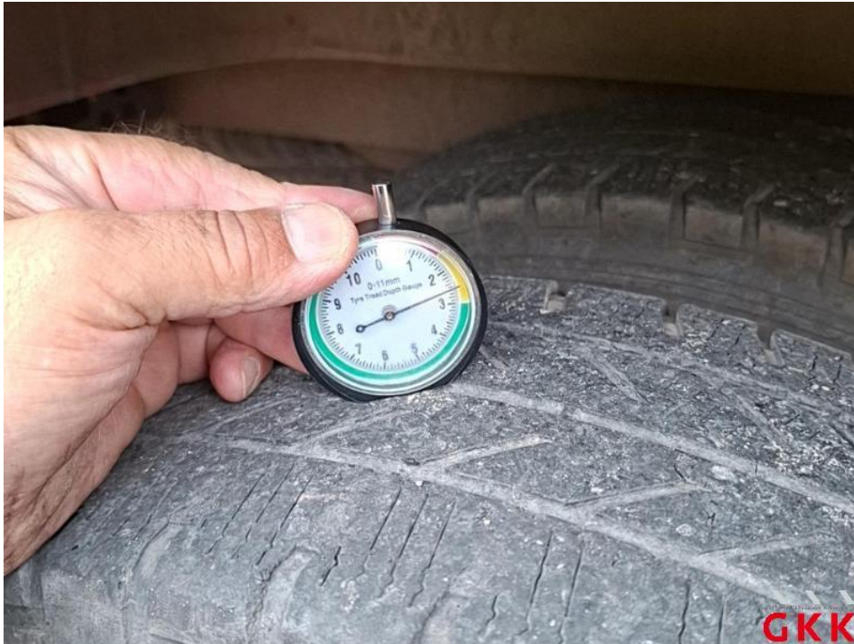
Bild 51. Satz Sommerreifen fehlt - falsche Reifenart, teilweise Untermaß, ersetzen
