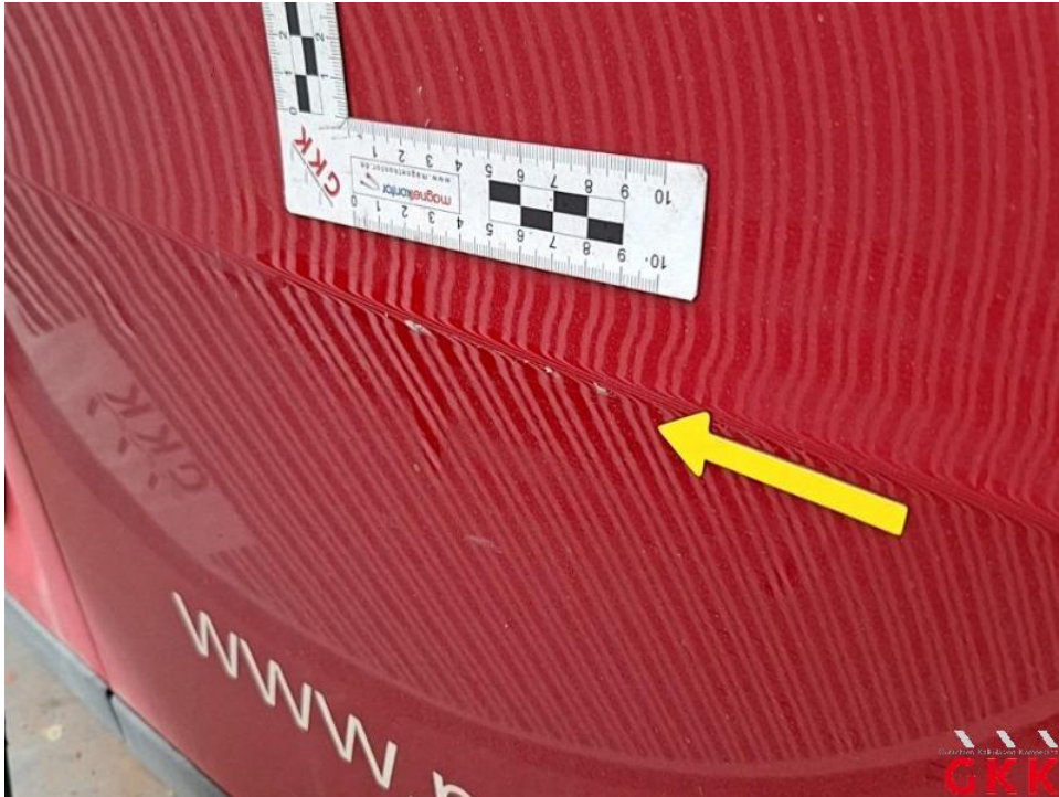
Bild 23. Hecktür rechts, beschädigt, instand setzen - lackieren
