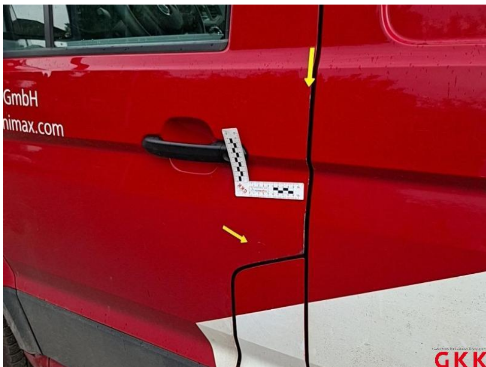
Bild 35. Tür vorne links, beschädigt, instand setzen - lackieren
