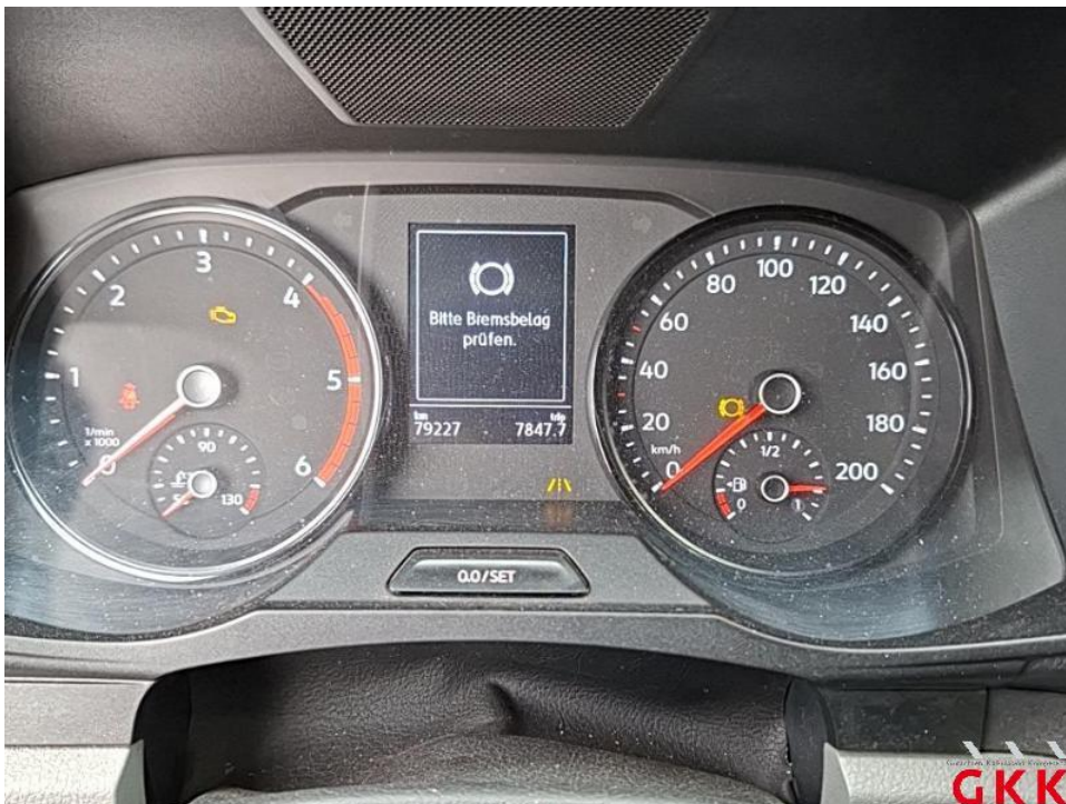
Bild 42. Bremsbeläge, vorne, Untermaß, ersetzen
