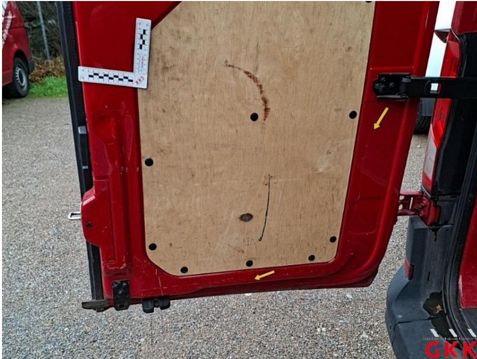
Bild 29. Hecktür links, innen, beschädigt, instand setzen - lackieren
