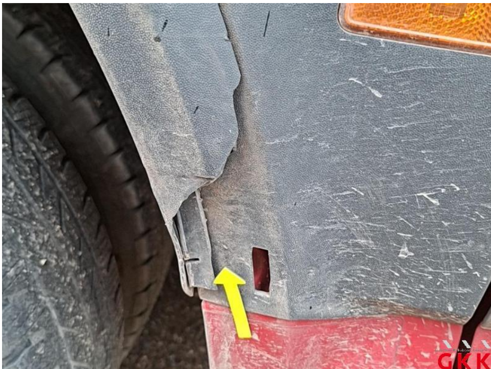
Bild 18. Seitenwand rechts, Leiste, Radlauf, beschädigt, ersetzen
