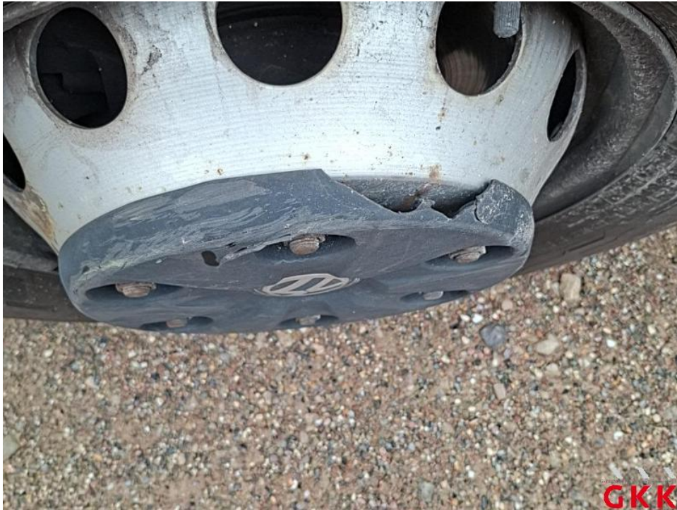
Bild 47. Radkappe(n), vorne links, gerissen, ersetzen
