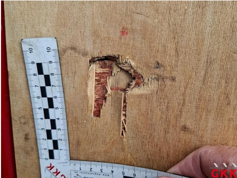
Bild 25. Hecktür rechts, Innenverkleidung, beschädigt, ersetzen
