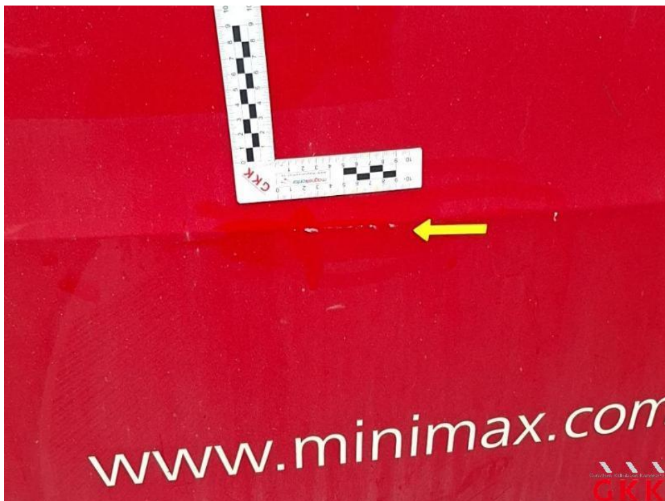
Bild 22. Hecktür rechts, beschädigt, instand setzen - lackieren
