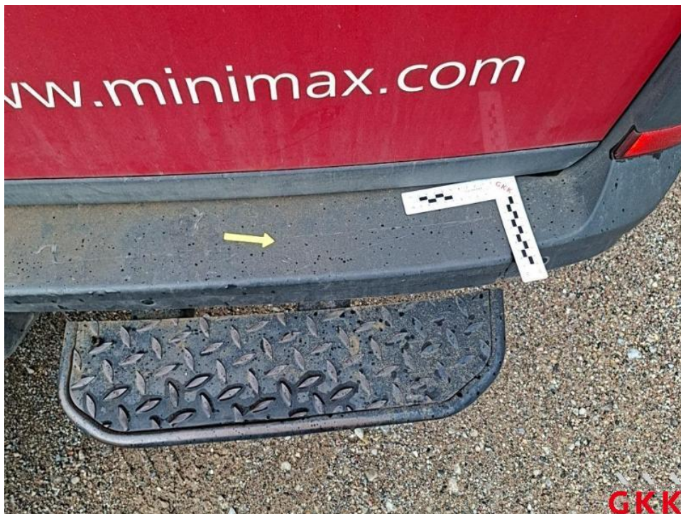
Bild 19. Stoßfänger hinten, Verkleidung -unlackiert-, beschädigt, ersetzen
