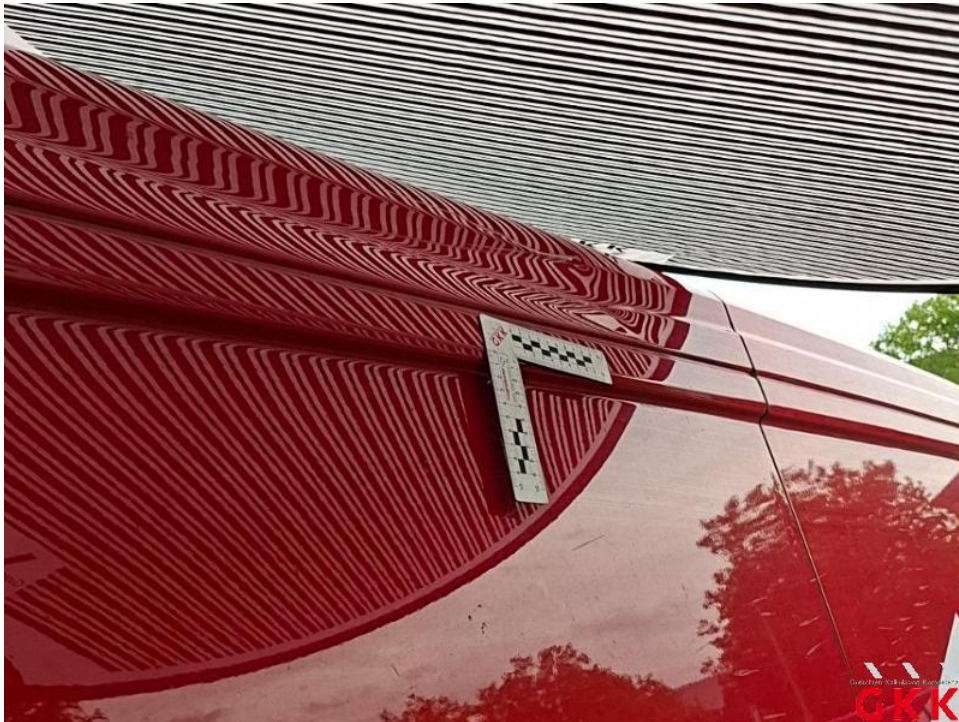
Bild 34. Dach, Mitte, beschädigt, instand setzen - lackieren
