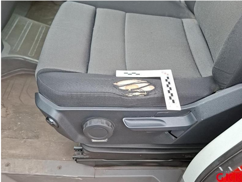
Bild 45. Sitz vorne links, Bezug Sitzkissen -Stoff-, gerissen, ersetzen
