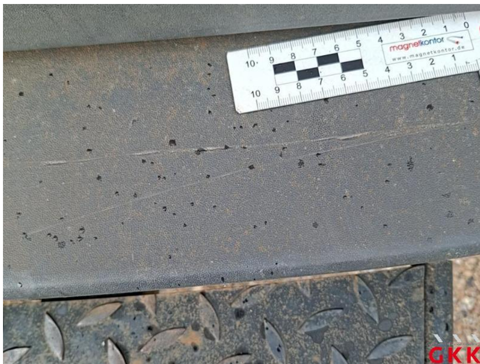
Bild 20. Stoßfänger hinten, Verkleidung -unlackiert-, beschädigt, ersetzen
