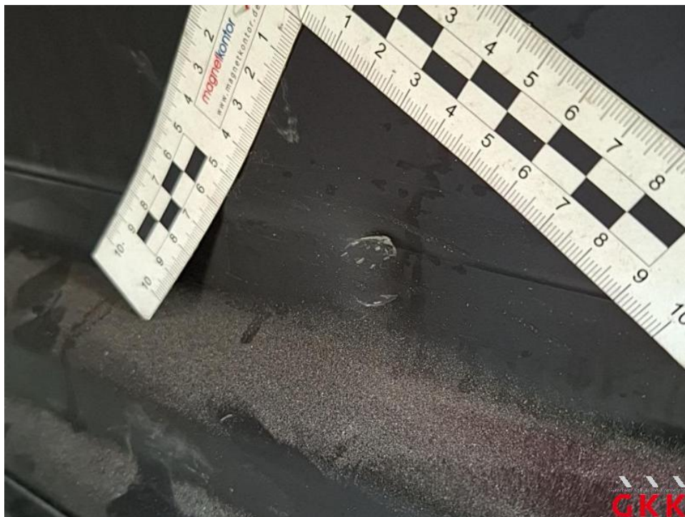
Bild 15. Trennwand, beschädigt, instand setzen - lackieren
