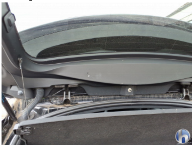
3. Laderaumabdeckung Beschädigt - Erneuern
