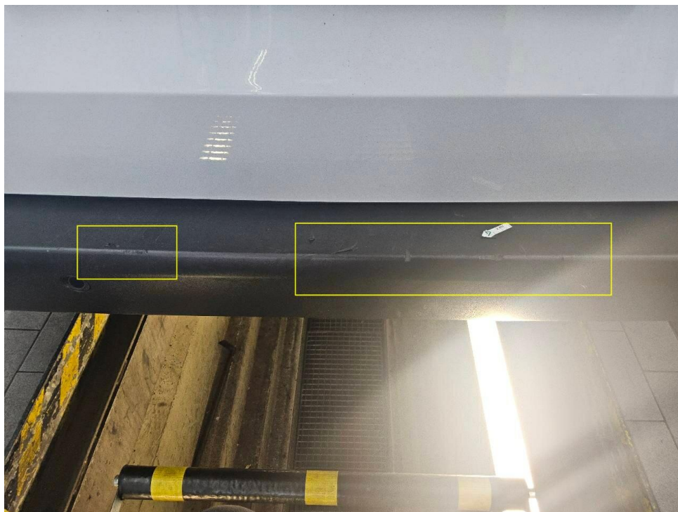
Bild 27 : Stoßfänger hinten, zerkratzt
