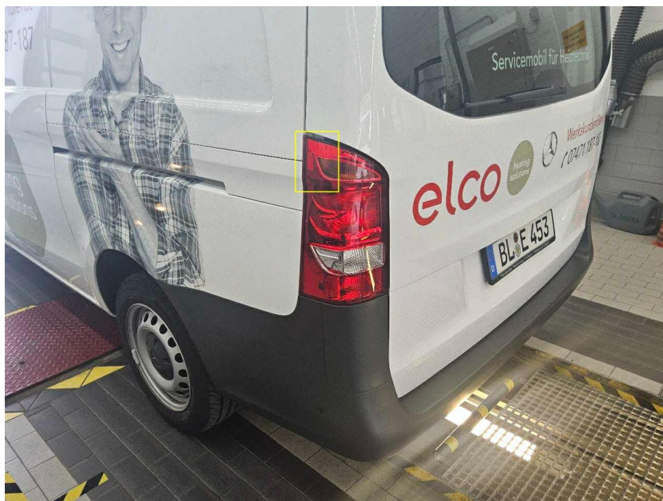
Bild 29 : Heckleuchte links, gerissen
