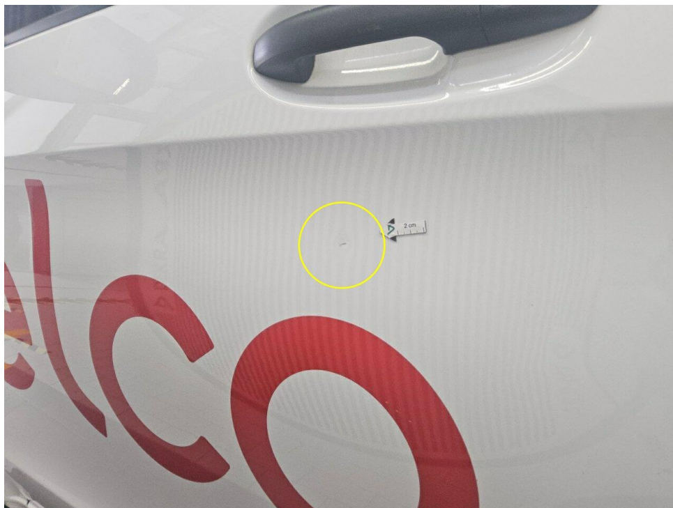
Bild 21 : Tür vorne links, eingedellt
