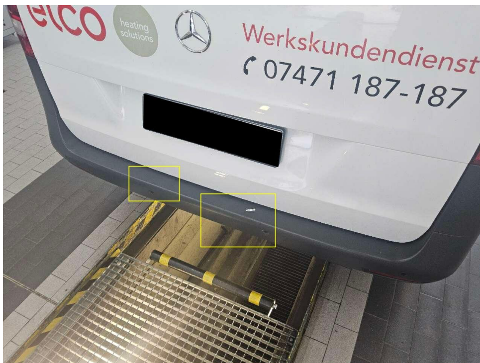
Bild 26 : Stoßfänger hinten, zerkratzt
