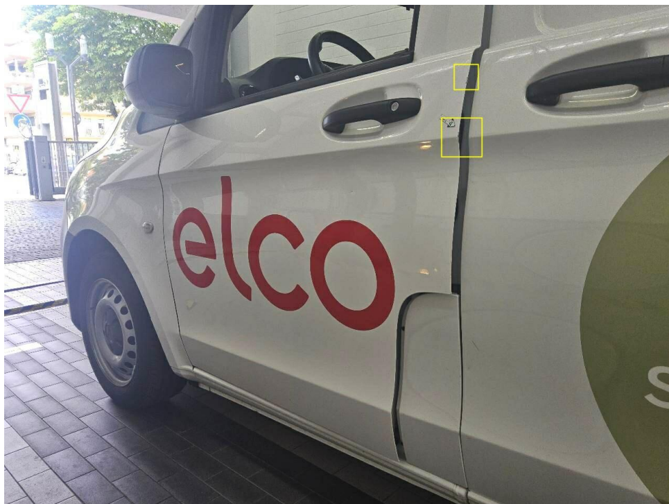
Bild 22 : Tür vorne links Kante, zerkratzt
