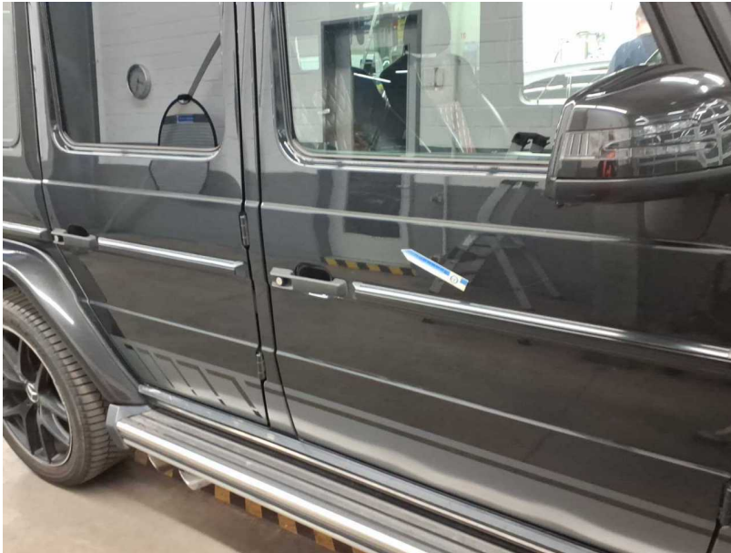
Beschädigung #4: Tür vorn rechts: Tür - Delle(n) - Smart Repair
