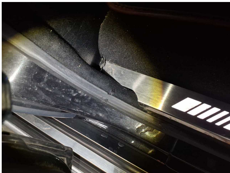
Beschädigung #9: Tür hinten links: Türdichtung - Brandloch - erneuern
