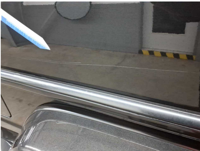
Beschädigung #17: Seitenwand rechts: Seitenwand - Kratzer - lackieren
