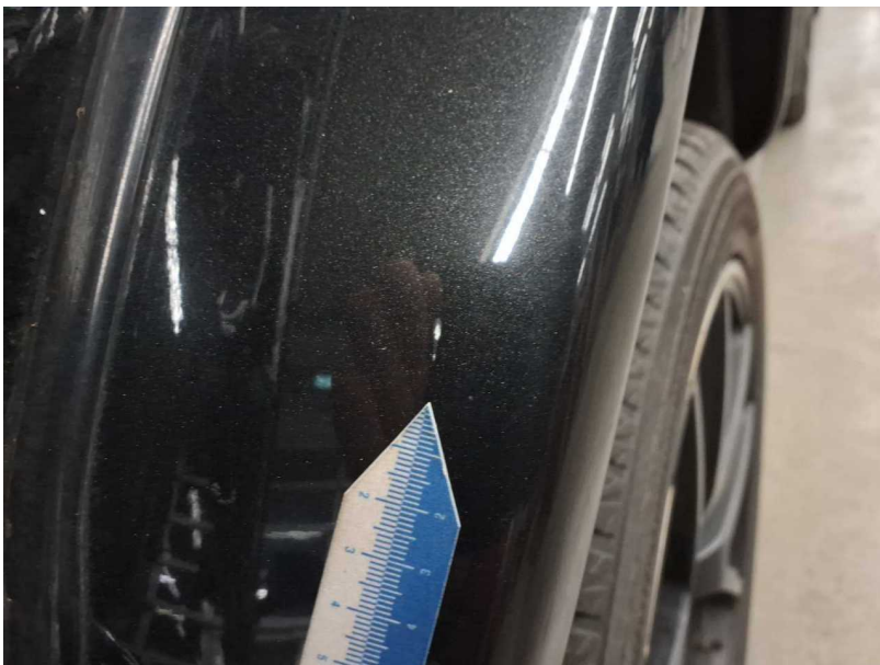
Beschädigung #2: Seitenwand links: Radhausverbreiterung - Kratzer - Smart Repair
