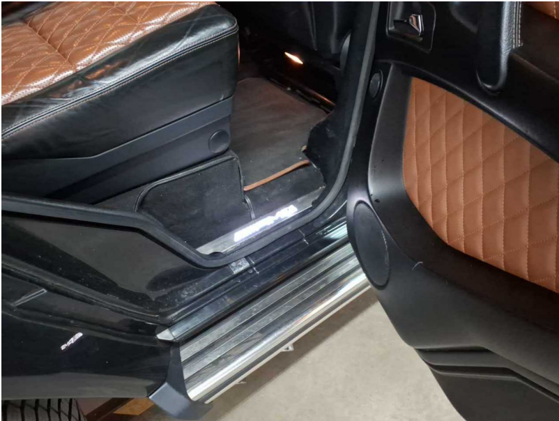
Beschädigung #18: Seitenwand rechts: Einstieg (AMG Blende) - verformt - erneuern
