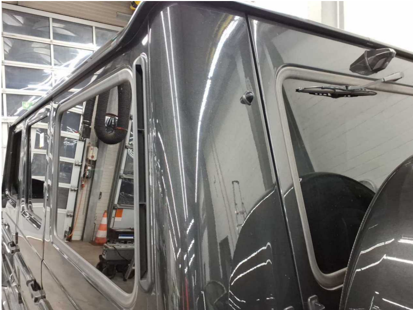
Beschädigung #20: Karosserie: Eckbeplankung links (Staubeingänge) - nicht fachgerecht instandgesetzt - lackieren
