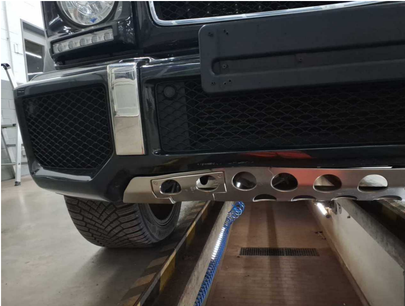
Beschädigung #27: Stossfänger vorn: Stossfänger vorn (inkl. Verkleidung unten) - verformt - erneuern
