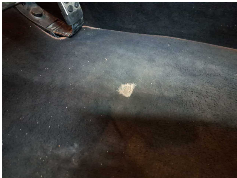
Beschädigung #3: Verkleidungen/Abdeckungen: Fußmatten - beschädigt - erneuern
