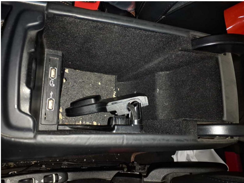
Beschädigung #12: Multimediasystem: Handyhalterung - beschädigt - erneuern
