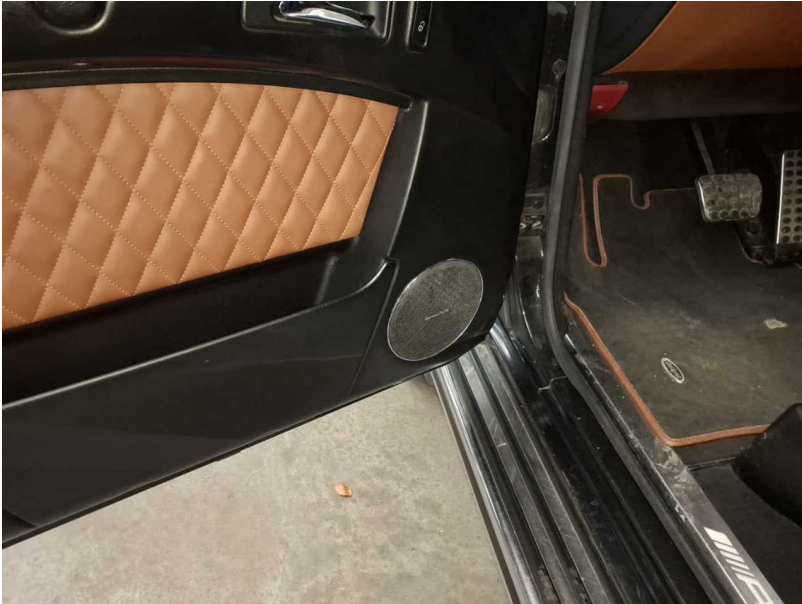
Beschädigung #1: Tür vorn links: Lautsprecherabdeckung - beschädigt - erneuern
