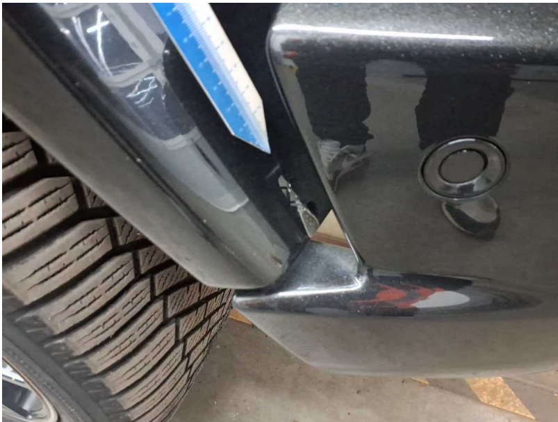
Beschädigung #14: Kotflügel rechts: Radhausverbreiterung - verkratzt / verschürft - lackieren
