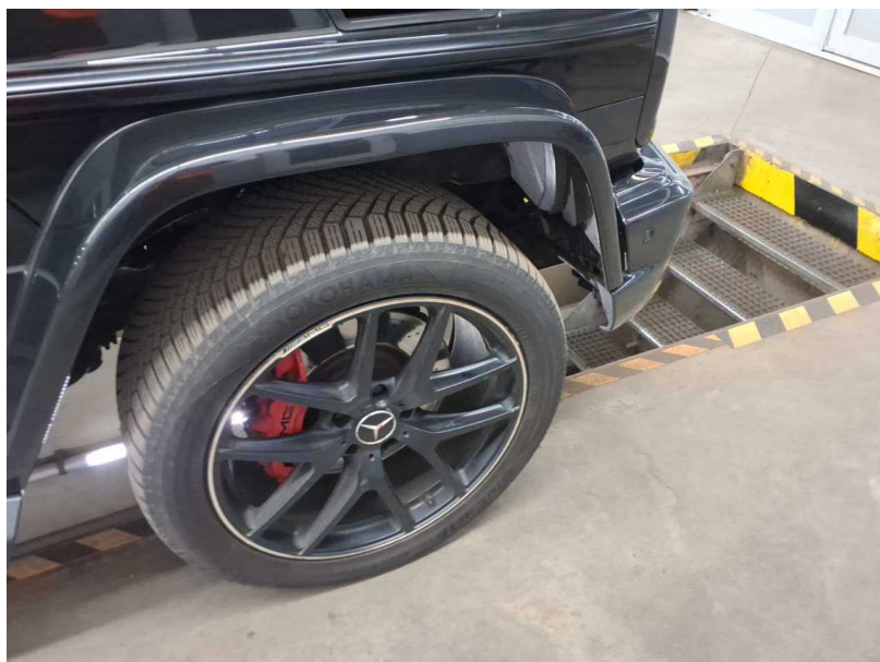
Beschädigung #24: Rad/Reifen: Leichtmetallfelge vorn rechts - verkratzt / verschürft - erneuern
