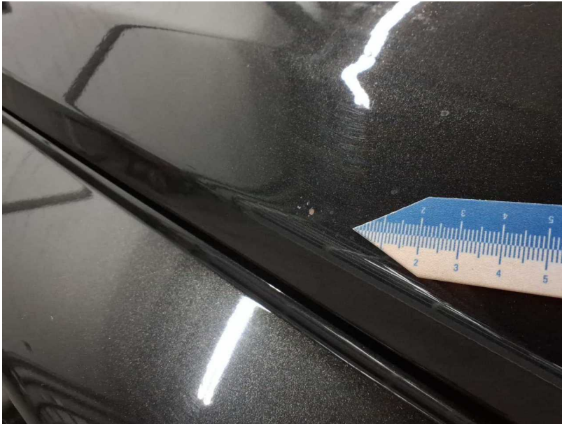
Beschädigung #16: Motorhaube: Motorhaube - Delle / Lackschaden - instandsetzen und lackieren
