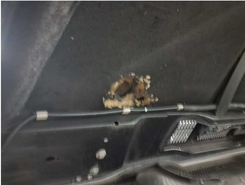
Beschädigung #10: Motorhaube: Dämmmatte - Marderschaden - erneuern
