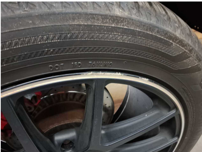
Beschädigung #23: Rad/Reifen: Leichtmetallfelge hinten links - verkratzt / verschürft - erneuern
