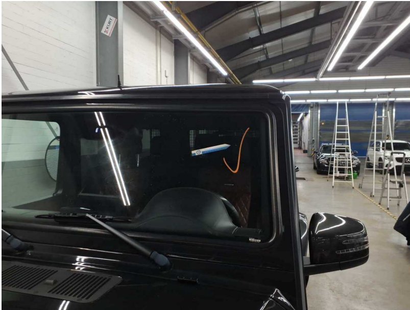
Beschädigung #26: Verglasung: Frontscheibe mit Regensensor - Steinschlag - erneuern
