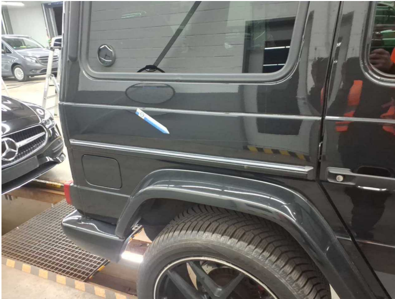
Beschädigung #17: Seitenwand rechts: Seitenwand - Kratzer - lackieren
