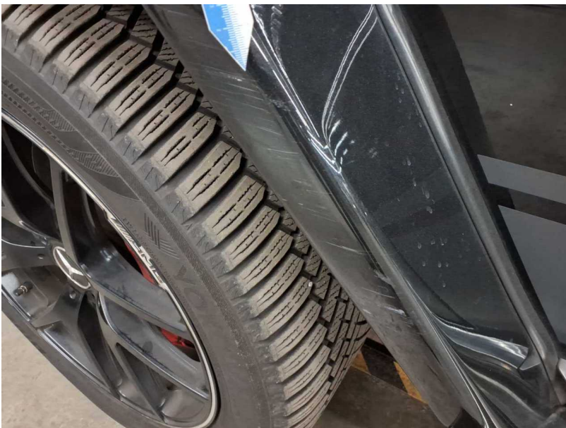
Beschädigung #13: Kotflügel links: Radhausverbreiterung - verkratzt / verschürft - lackieren
