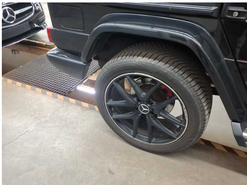
Beschädigung #25: Rad/Reifen: Leichtmetallfelge hinten rechts - verkratzt / verschürft - erneuern
