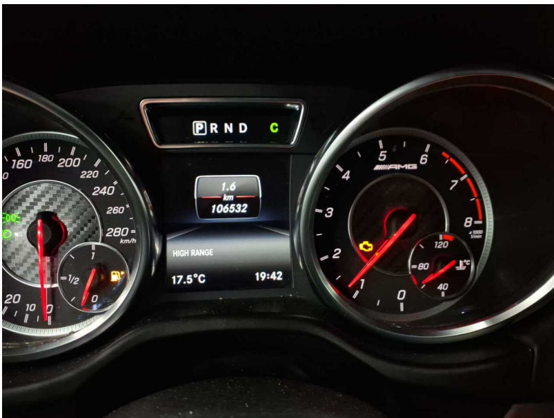
Beschädigung #11: elektronische Systeme: elektronische Systeme (KV-MKL: Lambdasonde) - leuchtet - erneuern
