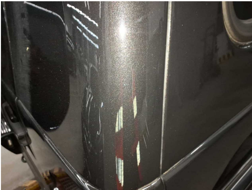
Beschädigung #5: Karosserie: Eckbeplankung rechts - Kratzer - Smart Repair
