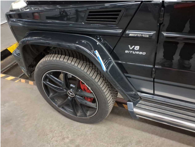
Beschädigung #13: Kotflügel links: Radhausverbreiterung - verkratzt / verschürft - lackieren
