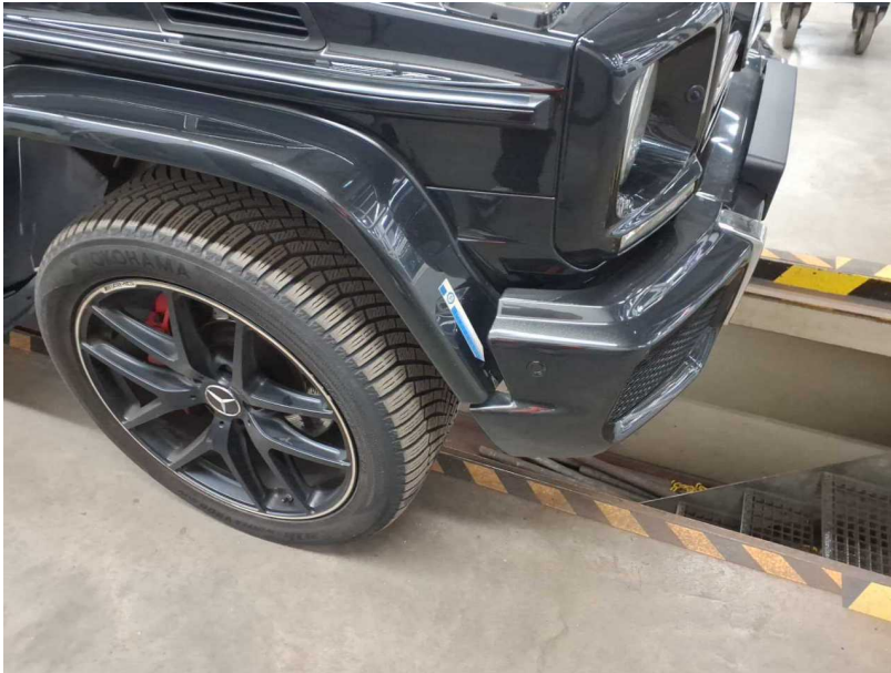
Beschädigung #14: Kotflügel rechts: Radhausverbreiterung - verkratzt / verschürft - lackieren
