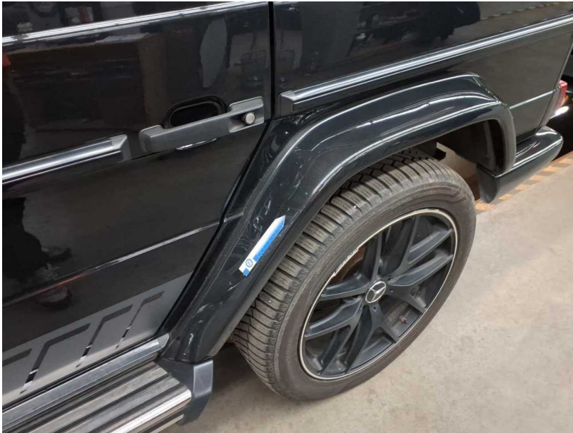
Beschädigung #2: Seitenwand links: Radhausverbreiterung - Kratzer - Smart Repair
